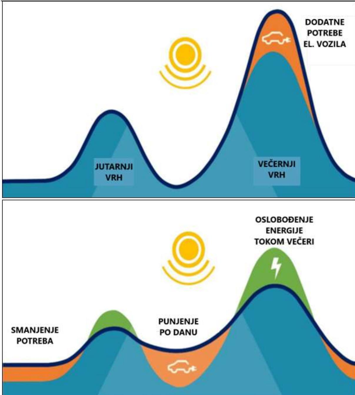
Slika 8.: Gornja slika prikazuje energetsko opterećenje u sadašnjoj infrastrukturi, a donja slika prikazuje energetsko opterećenja sadašnje energetske infrastrukture u kombinaciji s V2G tehnologijom [15].
