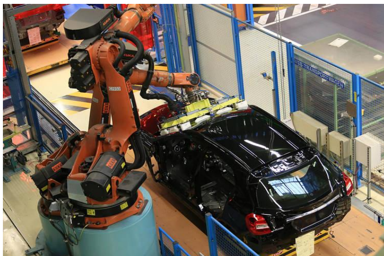
Slika 3.6 – Robotska ruka na hidrauličan pogon
