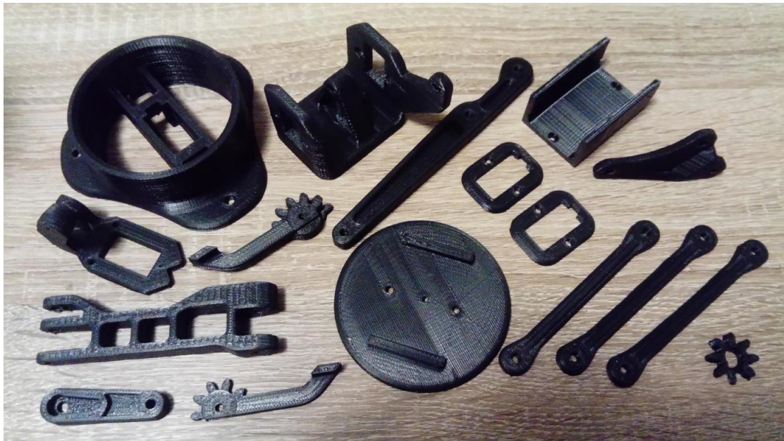
Slika 6.3 – Ispisani dijelovi modela robotske ruke
