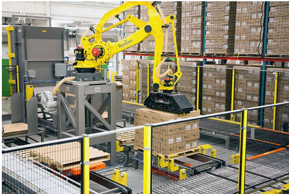
Slika 3.3 – Postupak paletiranja robotskom rukom
