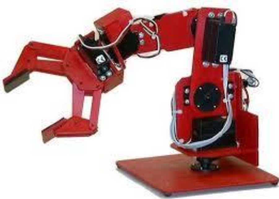
Slika 3.1 – Mehanička struktura robotske ruke s aktuatorima
