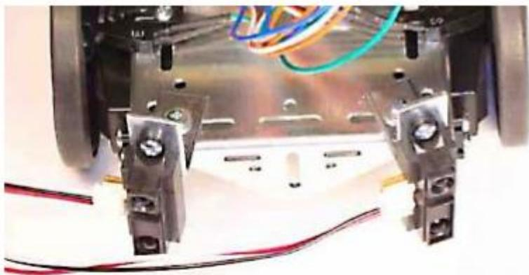
Slika 3.6 b) Prikaz robota nakon montaže senzora udaljenosti
