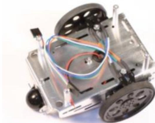
Slika 3.5 Prikaz nakon montaže servo motora, kotača i kuglastog kotača
