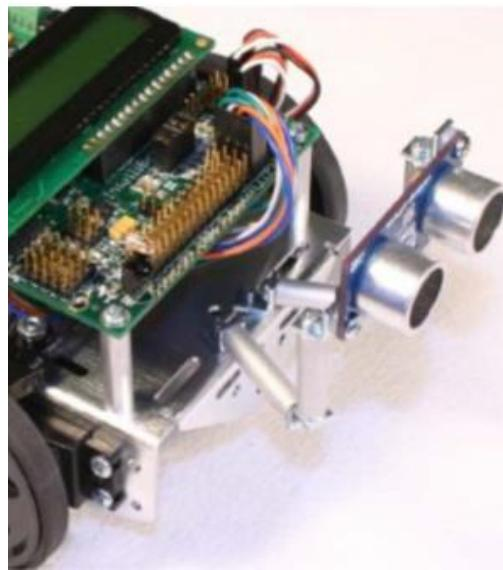
Slika 3.7 Prikaz robota nakon montaže ultrazvučnih senzora
