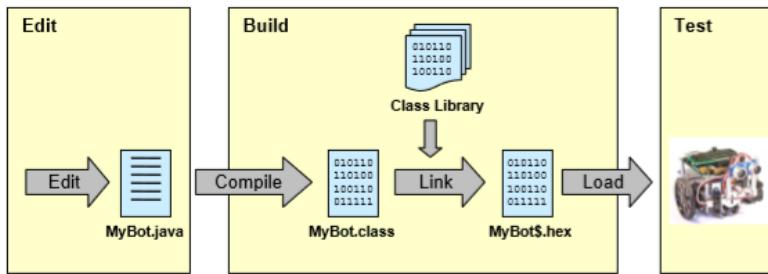
Slika 4.6 Proces izrade programa za mobilnog robota IntelliBrain-Bot
