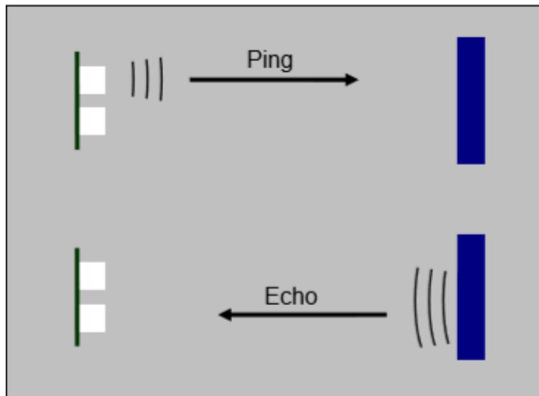
Slika 3.22 Mjerenje udaljenosti uz pomoć ultrazvučnog senzora
