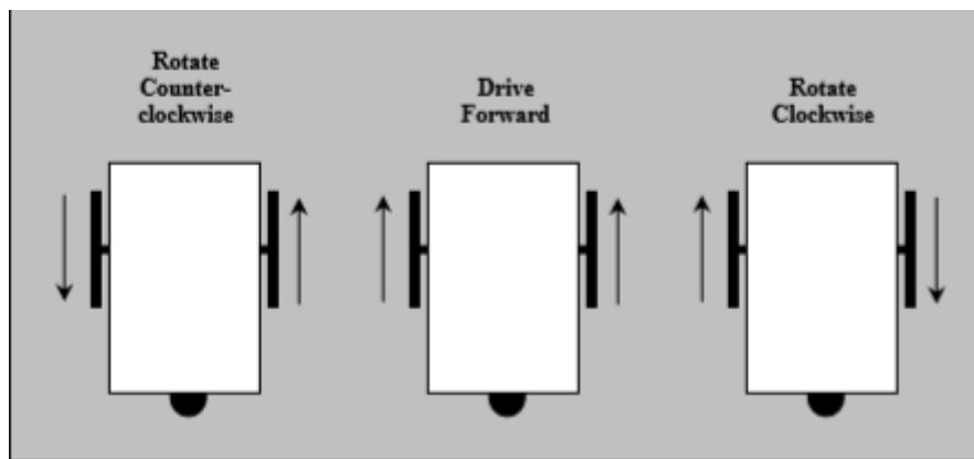
Slika 3.18 Prikaz diferencijalnog upravljanja kotača mobilnog robota
