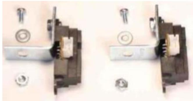
Slika 3.6 a) Postavljanje L nosača na senzore udaljenosti
