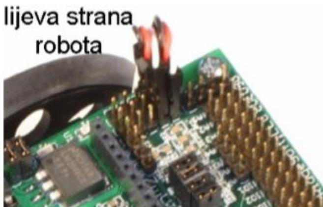
Slika 3.9 Povezivanje servo motora na upravljački kontroler
