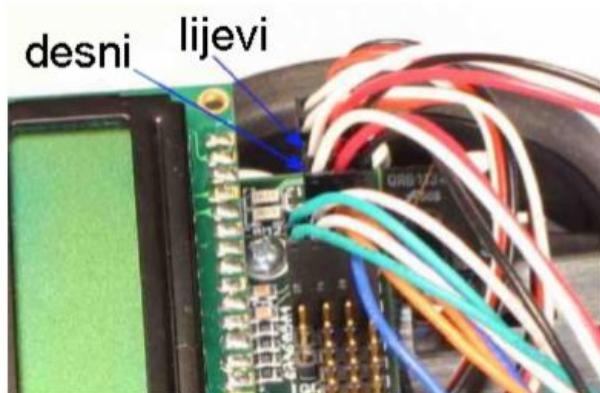
Slika 3.10 Spajanje senzora udaljenosti na upravljački kontroler robota
