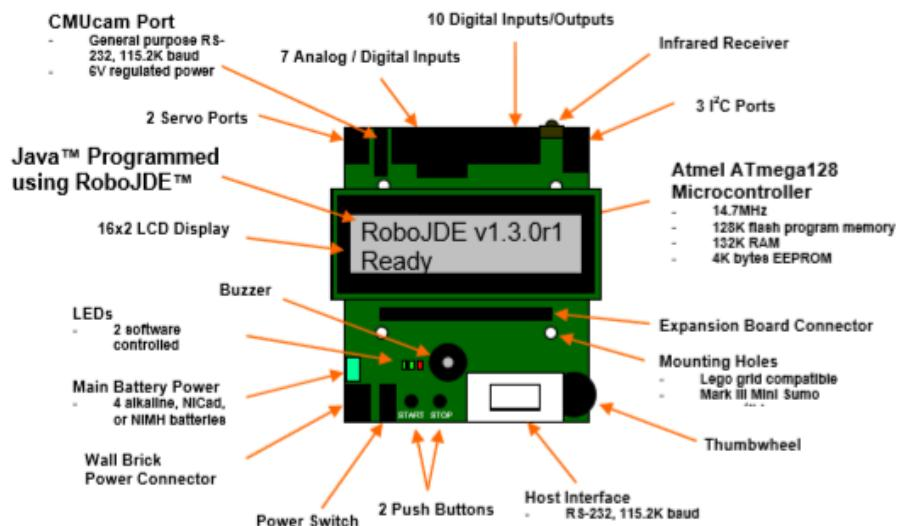
Slika 3.28 Prikaz elemenata glavne tiskane ploče mobilnog robota
