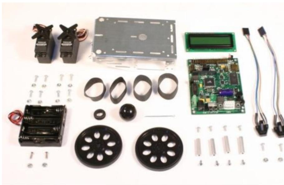
Slika 3.1 Dijelovi mobilnog robota u kit-kompletu
