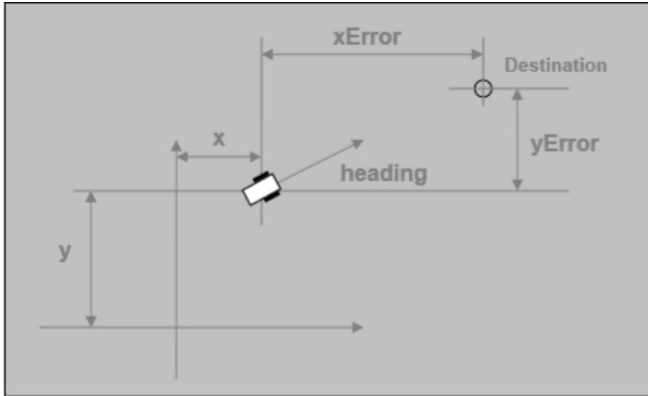
Slika 5.2 Navigacija mobilnog robota prema točki odredišta
