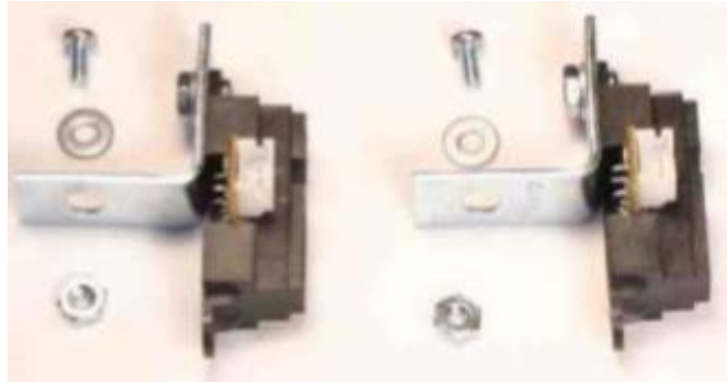
Slika 3.6 a) Postavljanje L nosača na senzore udaljenosti
