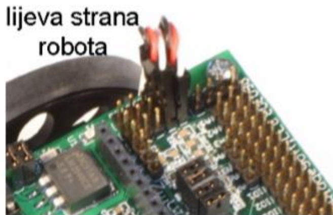
Slika 3.9 Povezivanje servo motora na upravljački kontroler
