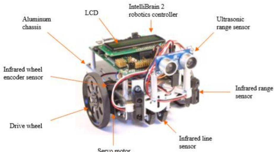
Slika 3.14 Detaljnija građa mobilnog robota tvrtke RidgeSoft
