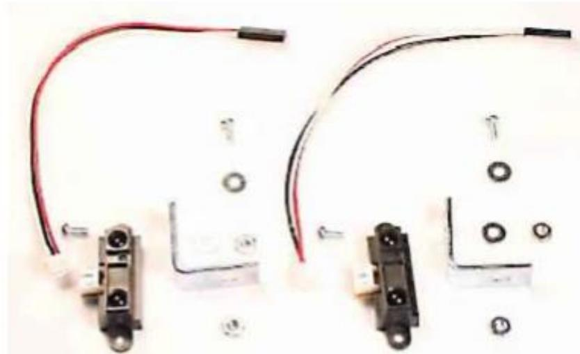
Slika 3.26 Senzori udaljenosti i dijelovi za njihovu montažu
