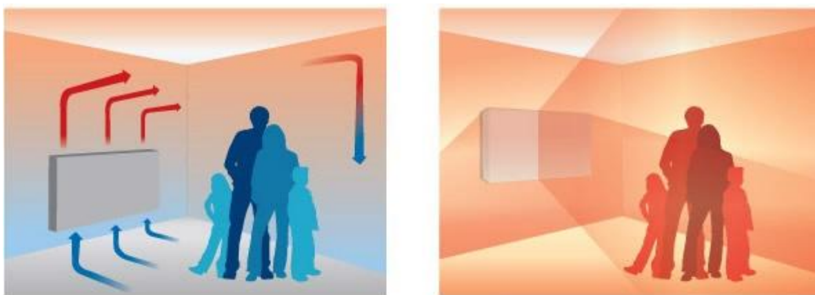
Slika 6. Lijevo - klasično (konvekcijsko) grijanje, desno - grijanje IC-panelima
