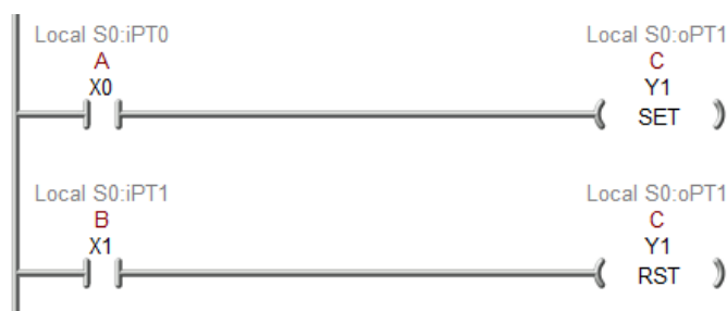
Slika 7.2 SET i RESET izlazi ljestvičastog dijagrama
