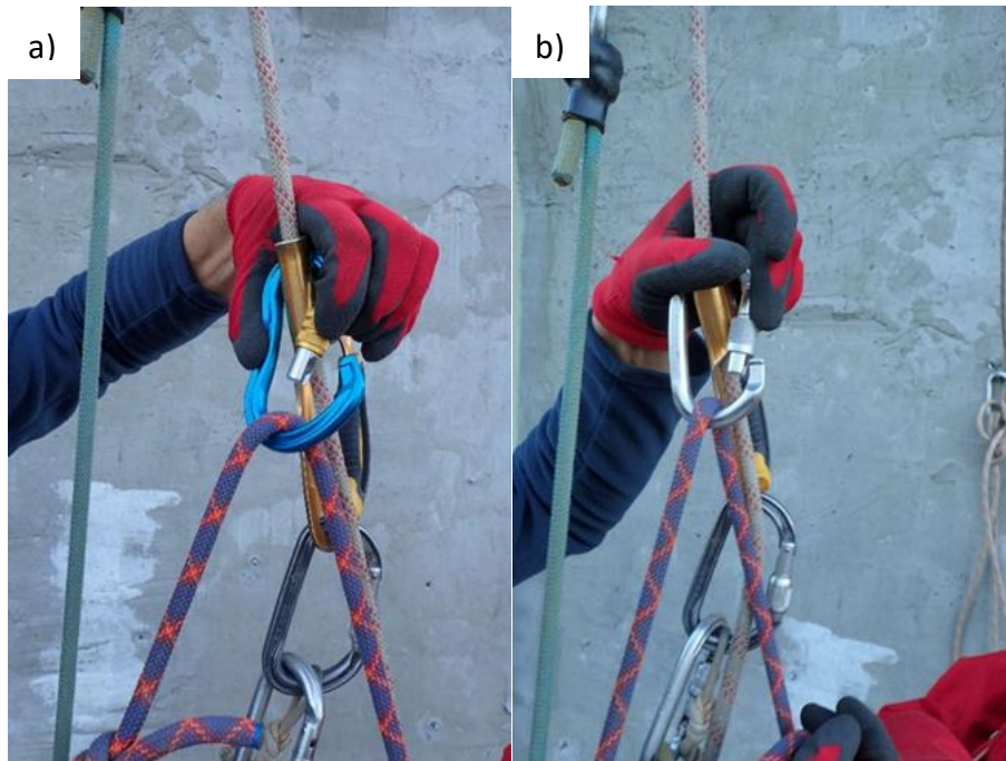
Slika 8: Radni prostor karabinera na gornjem otvoru blokera (Slika 8a: HMS karabiner; Slika 8b: ovalni karabiner)
