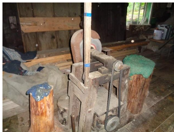
Slika 41- ručni bruser za žage
