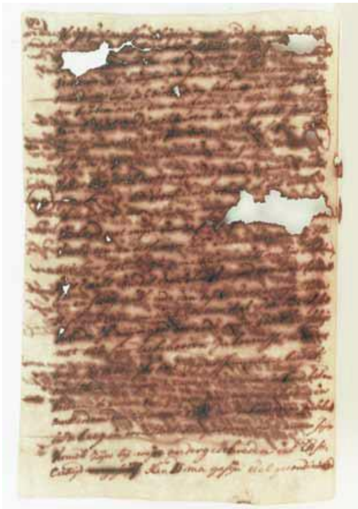
Slika 5. Korozija tinte i rupe u papiru
