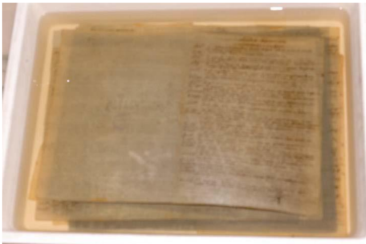
Slika 15. Neutralizacija u otopini kalcijevog hidroksida
