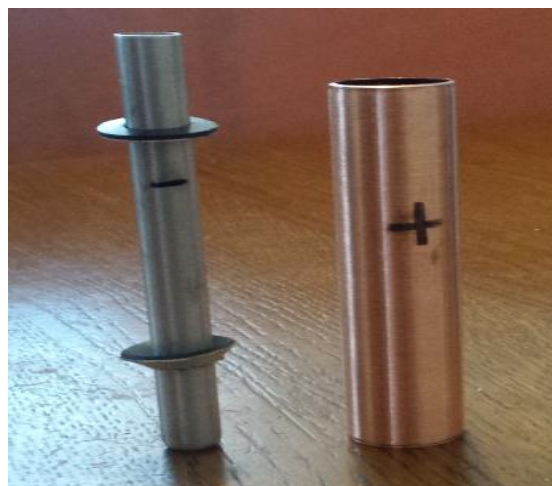
Slika 5.1.2 Stavljanje brtvi na aluminijsku cijev
