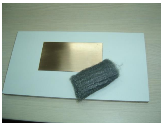
Slika 4.8. Čišćenje bakrene površine pločice.
