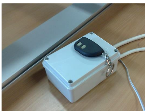
Slika 4.3. Sustav za daljinsko upravljanje
