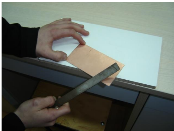
Slika 4.7. Uređivanje bridova pločice.
