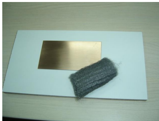
Slika 4.8. Čišćenje bakrene površine pločice.
