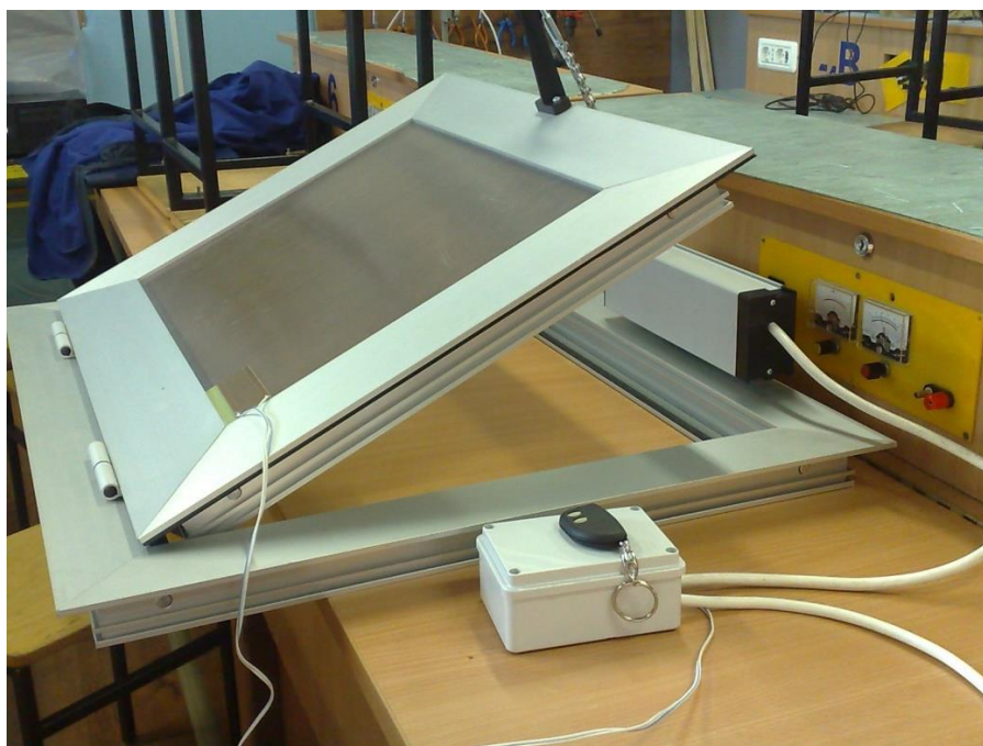
Slika 4.1. Prozor sa sustavom upravljanja.
