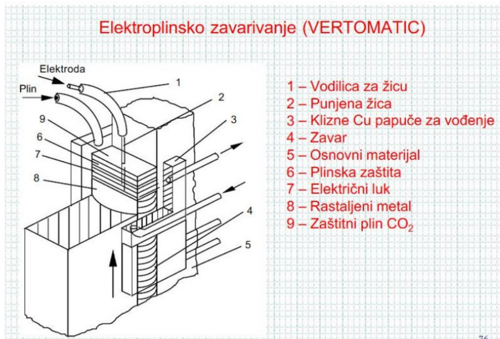
Slika 3.15. Osnovne komponente elektroplinskog zavarivanja
