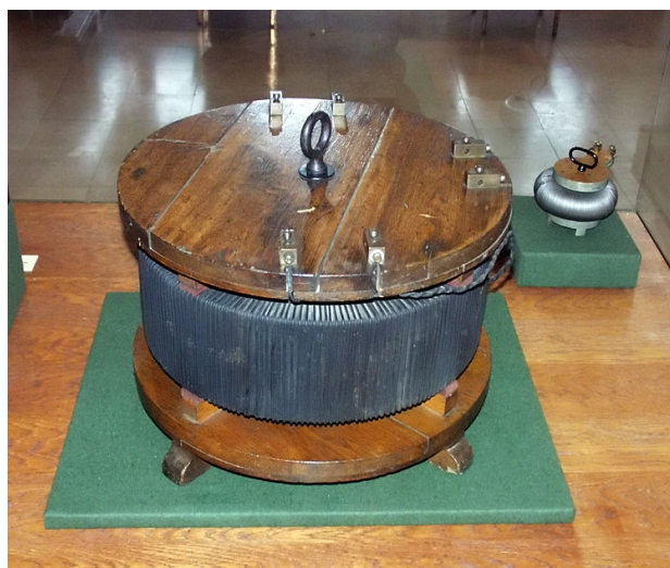
Slika 2.3 Suhi transformator ZBD tima
