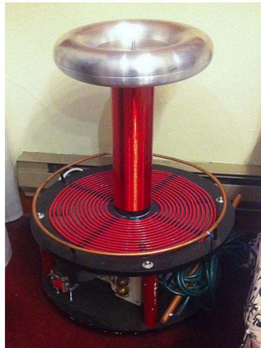
Slika 4.1 Moderno izveden Teslin transformator
