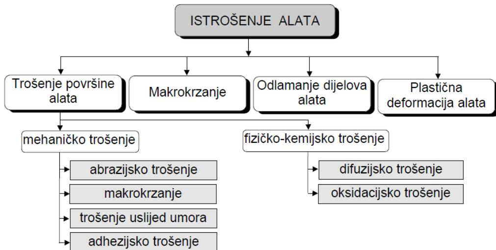
Slika 2.16. Shema osnovnih oblika trošenja [1]
