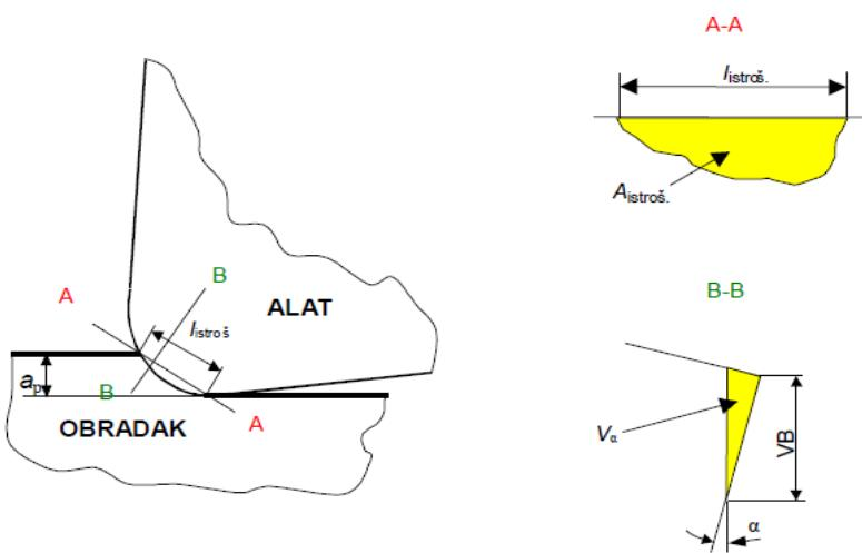
Slika 2.13. Prikaz istrošenja poleđine alata [1]
