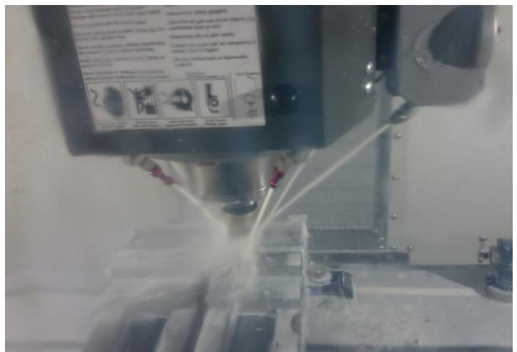
Slika 3.20. *Primjena SHIP-a pri obradi odvajanjem čestica*
