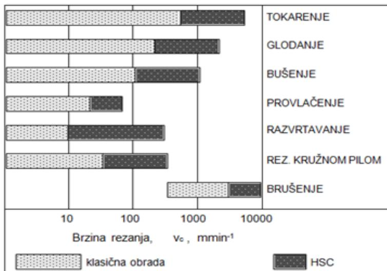
Slika 2.4. Podjela područja brzina rezanja čelika po Icksu [4]
