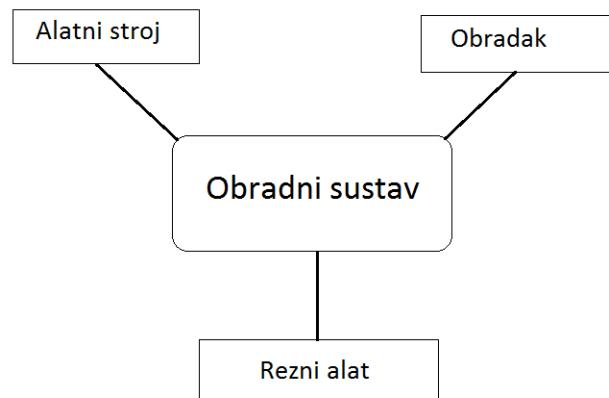
Slika 1.1. Shema osnovnih elemenata obradnog sustava
