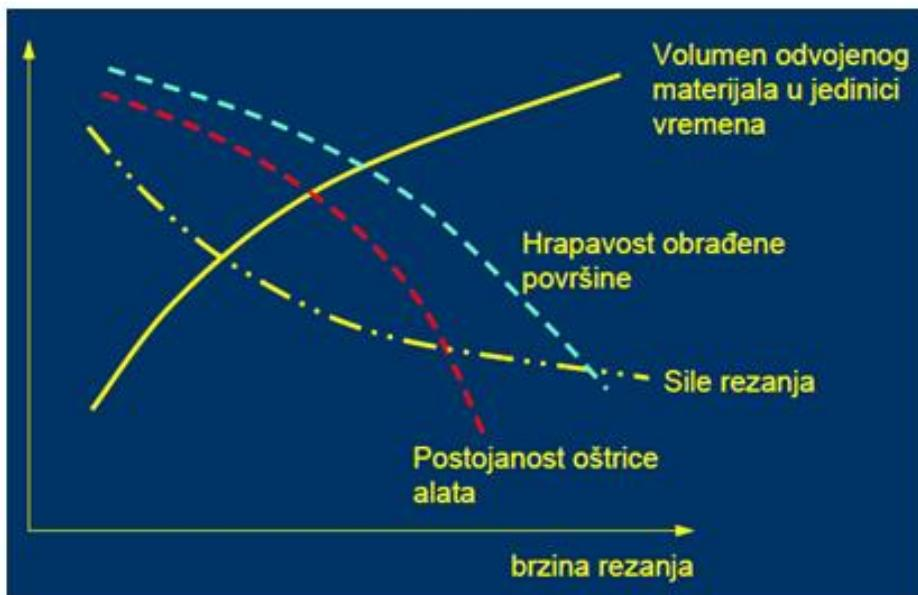
Slika 2.5. Značajke VBO ovisne o brzini rezanja ( $vc$ ) [4]
