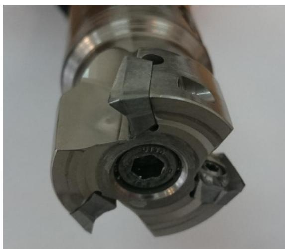
Slika 3.11. Glodalo s pločicama za obradu aluminija
