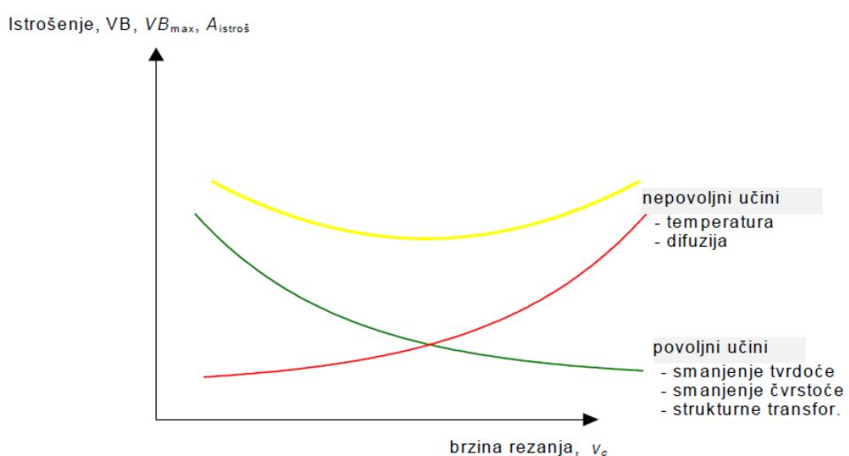
Slika 2.17. Učini trošenja alata [1]
