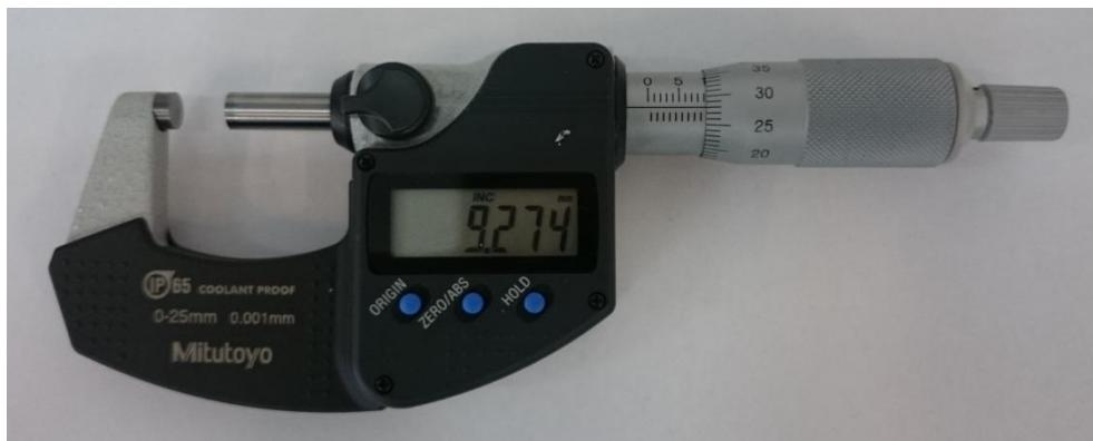
Slika 3.22. Digitalni mikrometarski vijak
