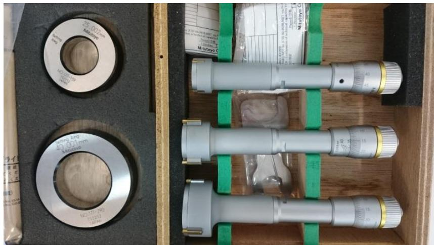
Slika 3.24. Mikrometar za provrte s kontrolnim prstenovima
