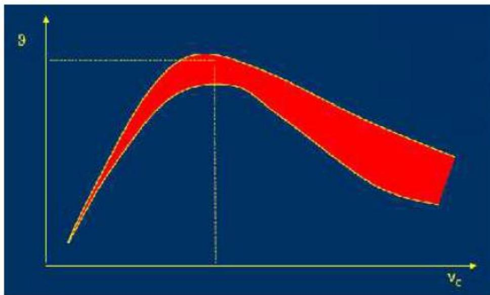
Slika 2.3. *Ovisnost temperature o brzini rezanja* [7]
