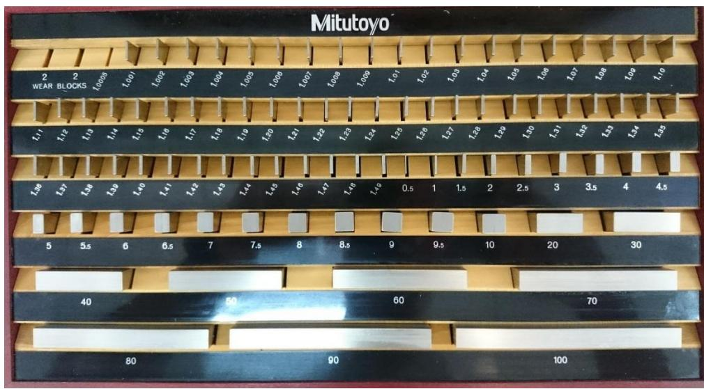
Slika 3.23. Mjerne pločice „etaloni“
