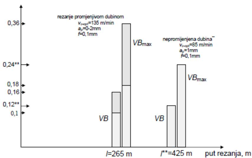
Slika 2.8. Utjecaj promjenjivosti dubine rezanja na istrošenje alata [1]
