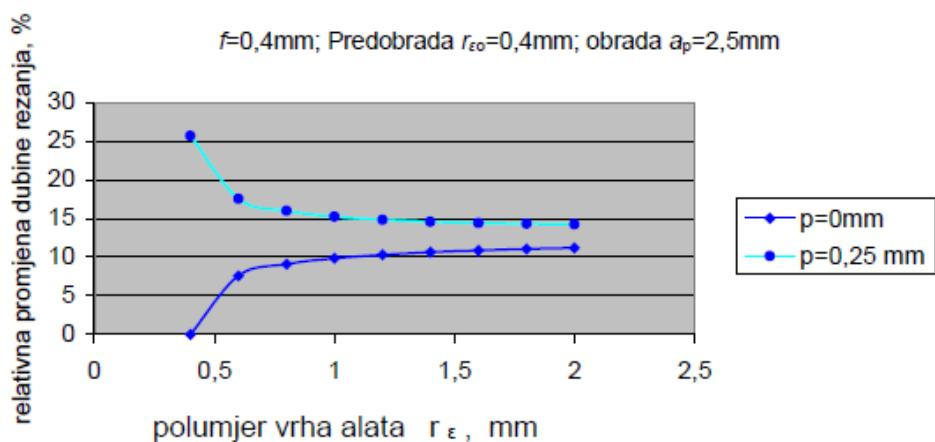
Slika 2.10. Ovisnost relativne promjenjivosti dubine rezanja o radijusu vrha alata [1]
