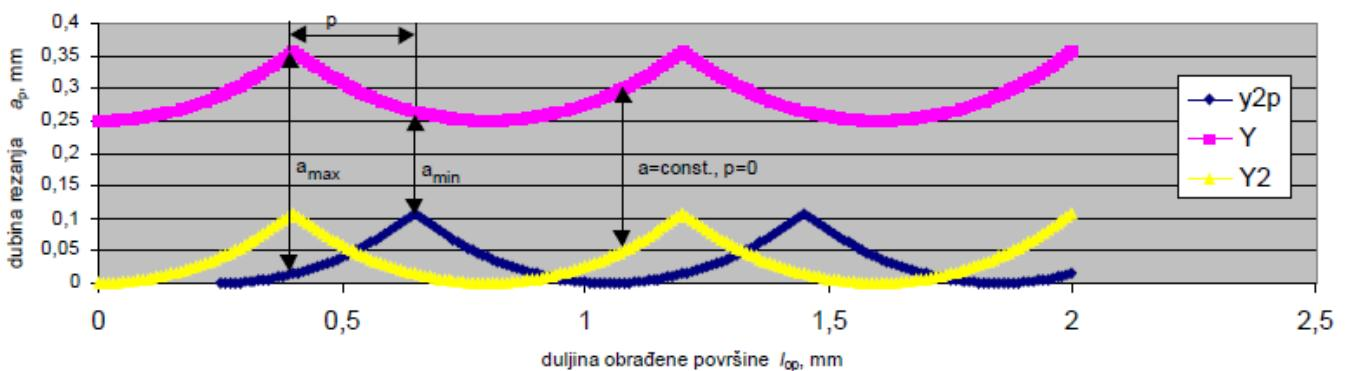
Slika 2.9. Parametri za izračun relativne promjene dubine rezanja [1]
