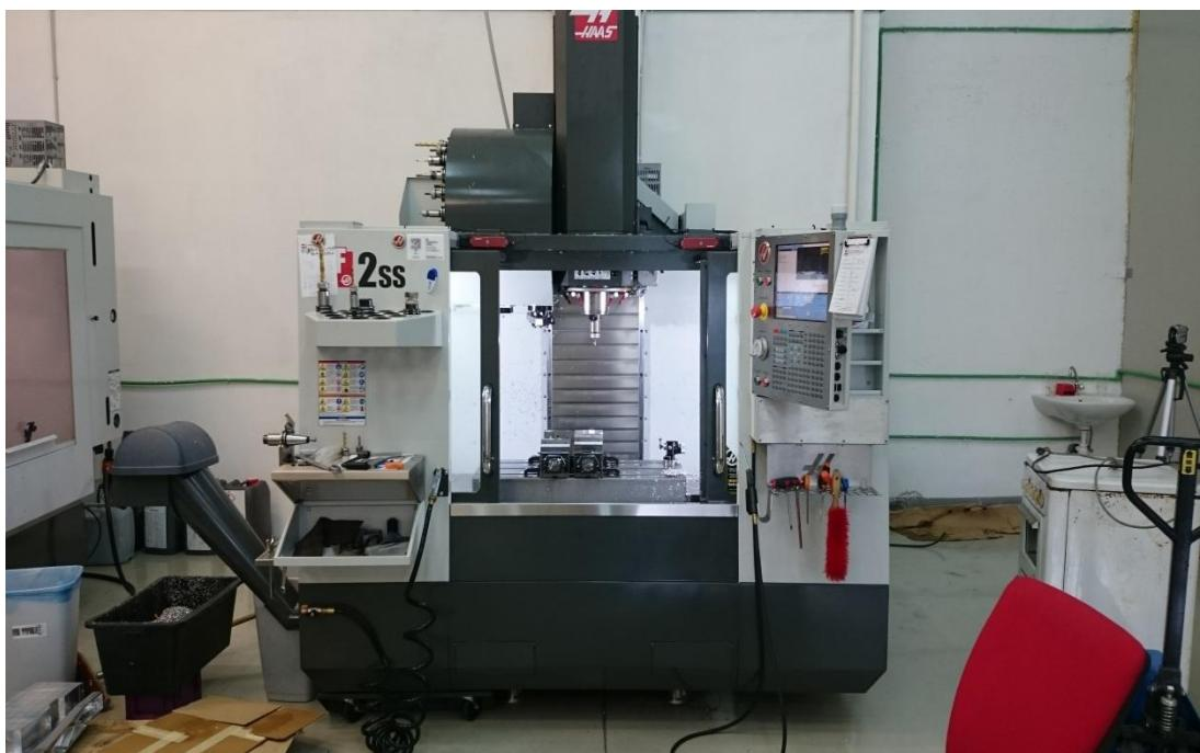
Slika 3.1. *CNC obradni centar „Haas VF-2SS“*
