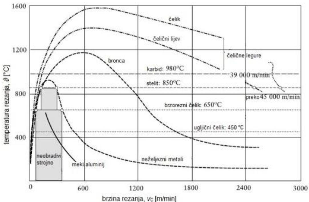
Slika 2.1. Ovisnost temperature o brzini rezanja kod glodanja [4]
