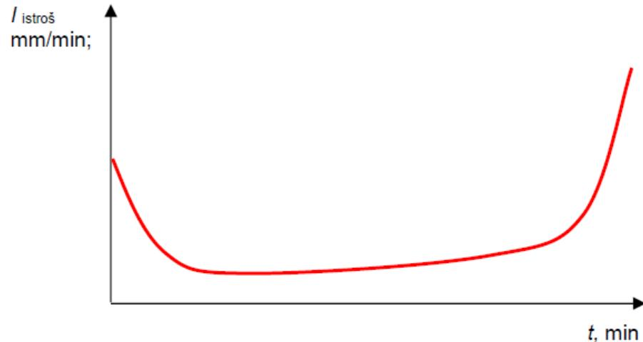
2.15. Intenzitet trošenja alata [1]
