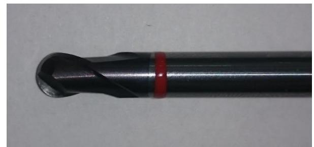
Slika 3.12. Glodalo „Kugla“ za obradu zahtjevnih mjesti i oblika
