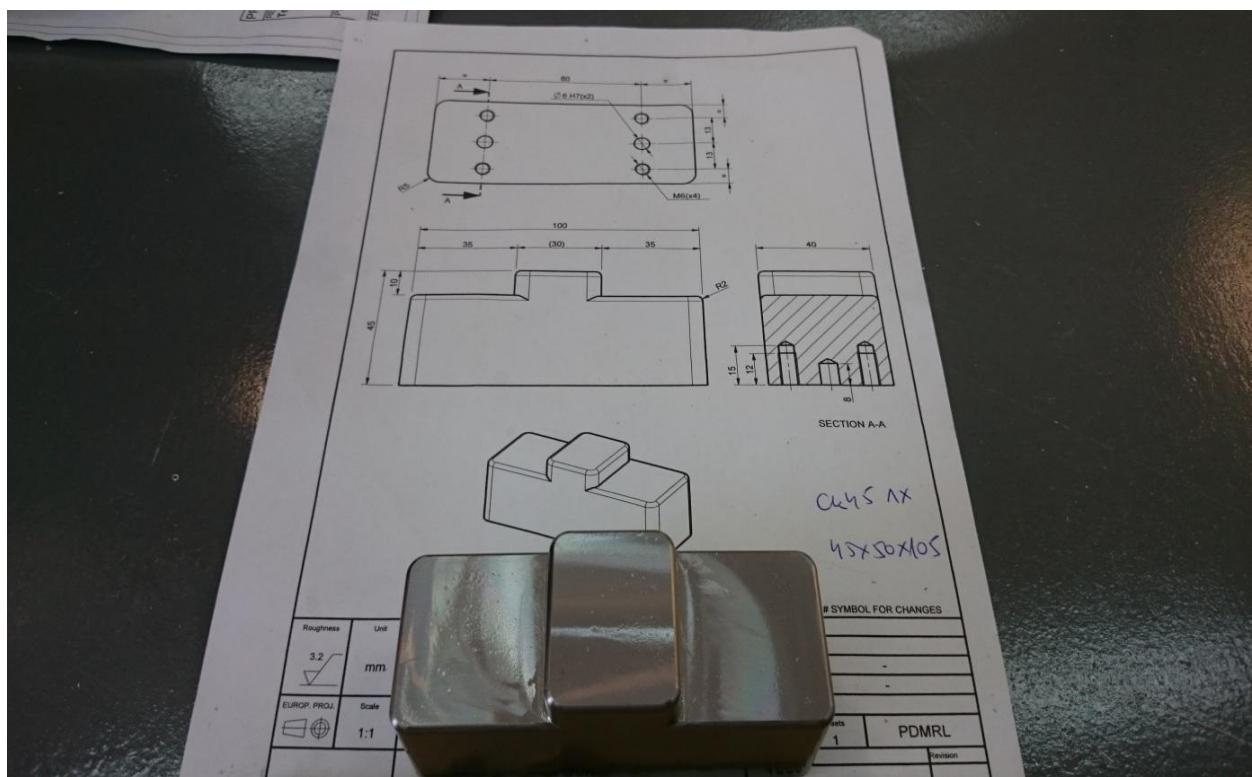
Slika 3.28. Prikaz gotovog obratka sa pripadajućim tehničkim crtežom
