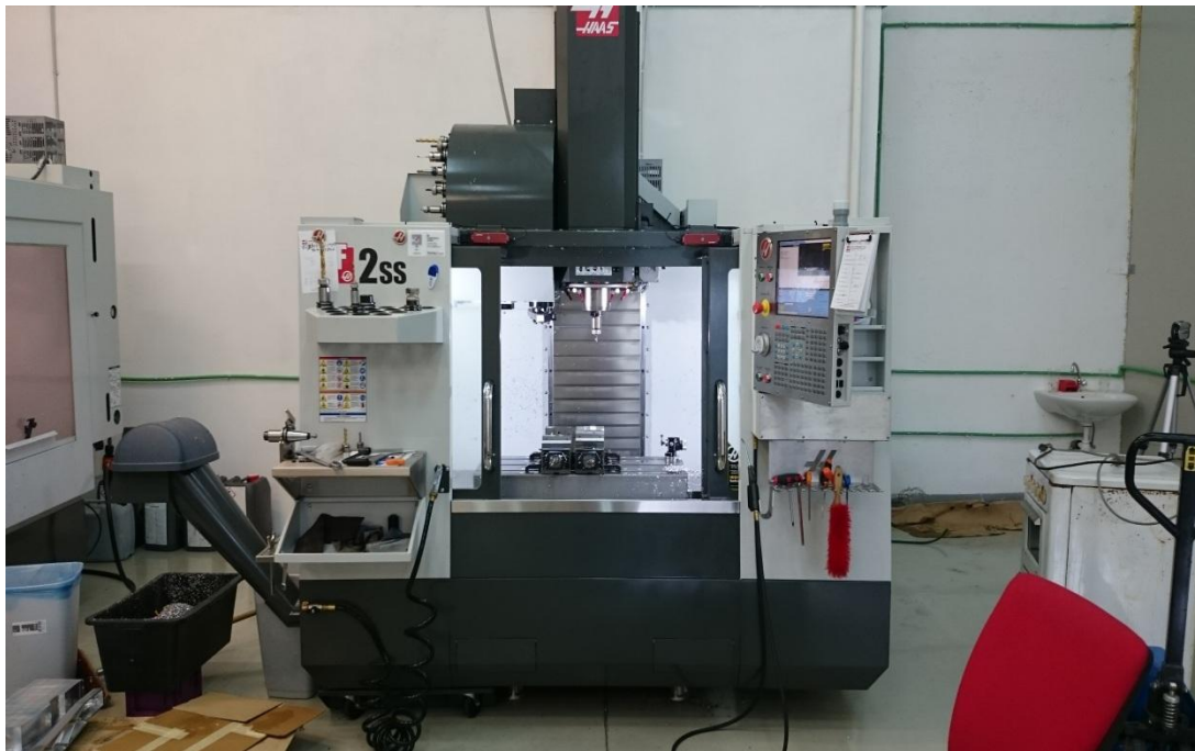
Slika 3.1. CNC obradni centar „Haas VF-2SS“
