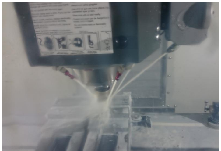
Slika 3.20. Primjena SHIP-a pri obradi odvajanjem čestica
