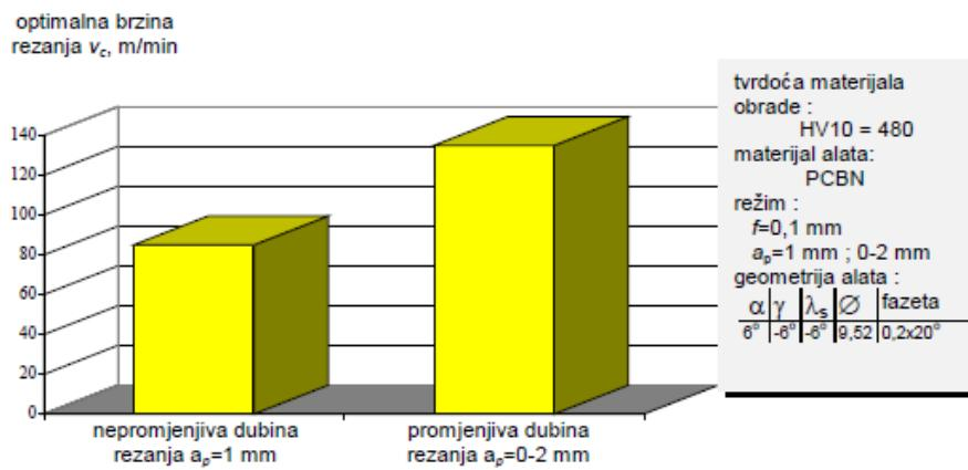
Slika 2.7. Utjecaj promjenjivosti dubine rezanja na optimalnu brzinu [1]
