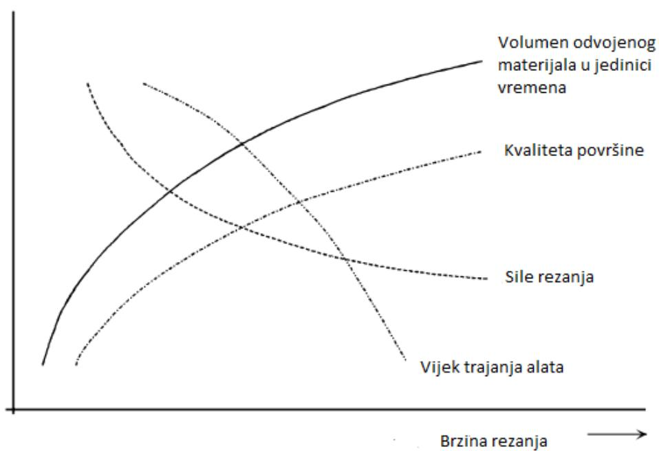
Slika 2.2. *Opća svojstva visokobrzinske obrade* [4]
