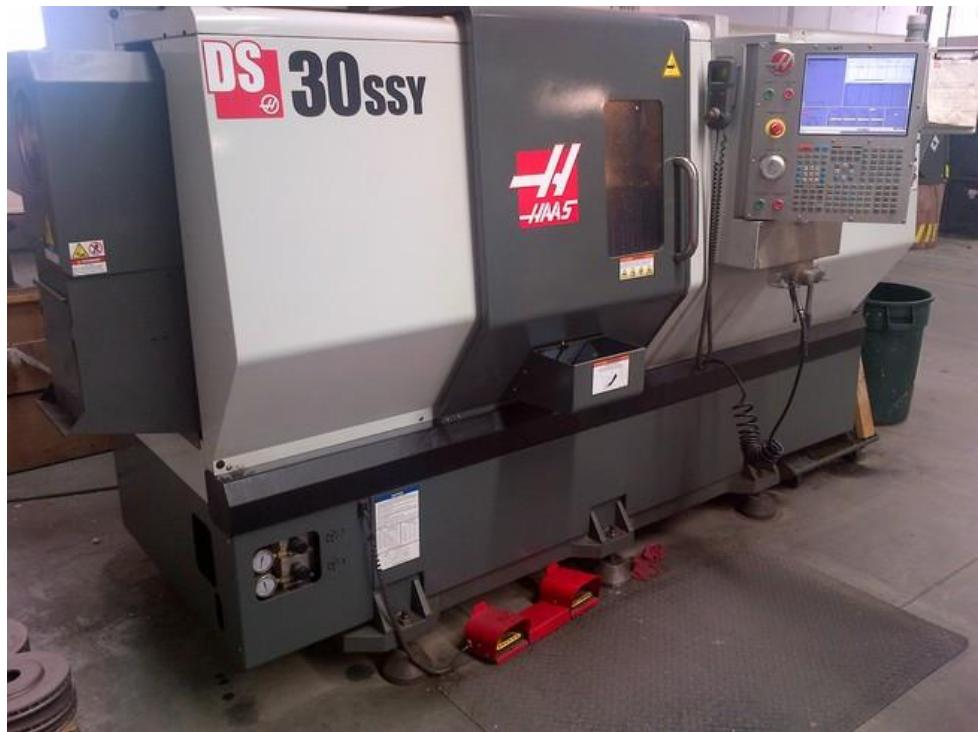
Slika 3.8. Tokarski obradni centar „Haas DS-30SSY“[10]
