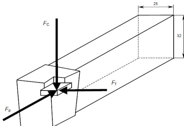
Slika 2.20. Prikaz komponenata sila rezanja [1]
