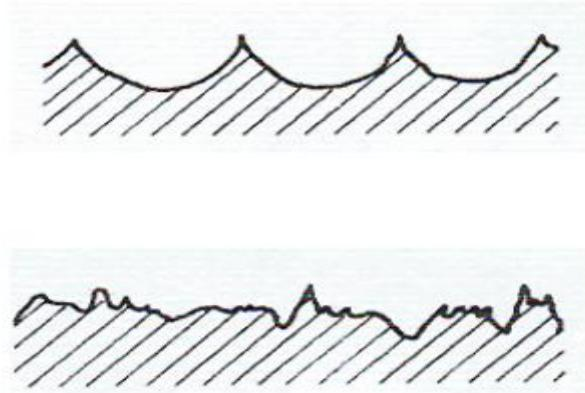
Slika 2.19. Periodični i neperiodični profil površine obratka [8]
