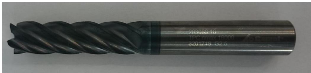
Slika 3.9. TPC glodalo za čelik („Trochoidal Performance Cutting“)
