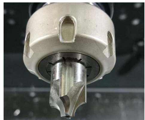
Slika 3.14. Glodalo za izradu zaobljenih rubova
