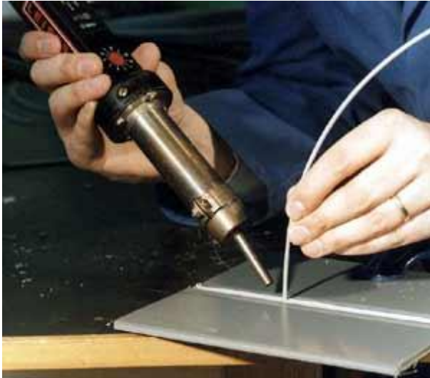
Slika 3.4. Prikaz zavarivanja polimernog materijala vrućim plinom [6]
