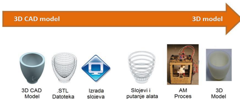
Slika 4.2. Faze brze izrade prototipova
