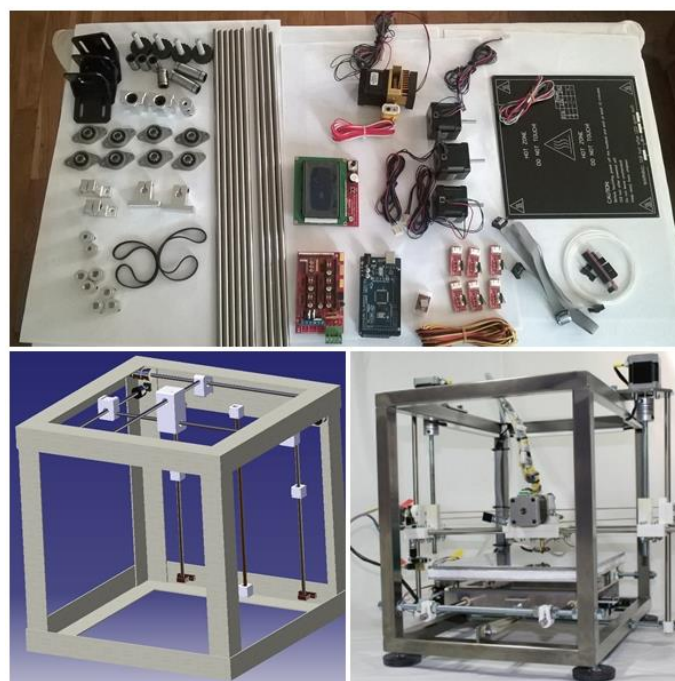
Slika 6.11. Konstrukcija i dijelovi 3D printera
