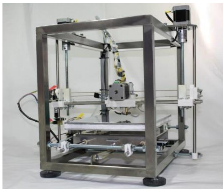
Slika 5.2. Izgled 3D printera domaće izrade
