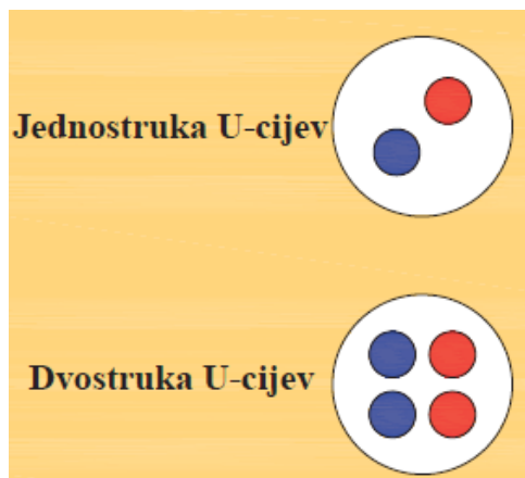
Slika 10. : Način izvedbe sonde [7]
