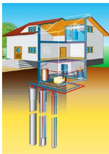
Slika 9: Izvedba sa dubinskom sondom [9]
