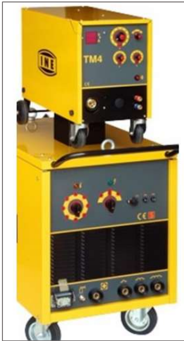
Slika 2.6. Uređaj za MAG zavarivanje [9]
