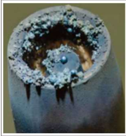
Slika 2.33. Čahura začepljena zbog prskanja kapljica [9]
