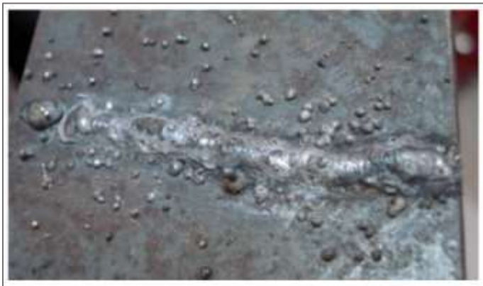
Slika 2.32. Zavar izveden globularnim režimom rada [9]
