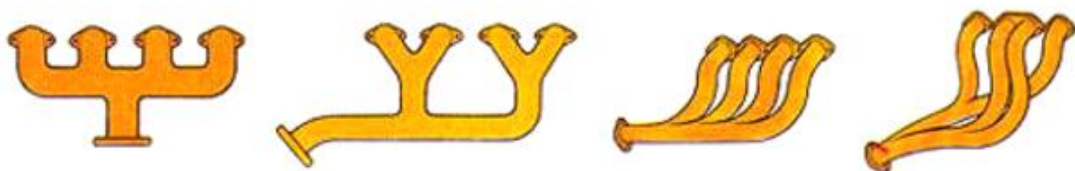
Slika 2.25. Primjeri konstrukcije ispušnog kolektora [21]
