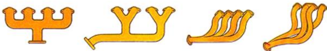
Slika 2.25. Primjeri konstrukcije ispušnog kolektora [21]
