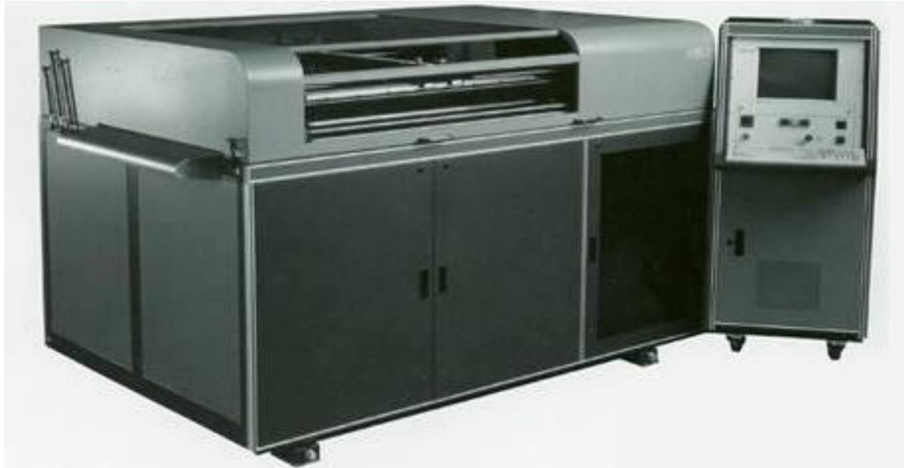
Slika 3.5. Uređaj Helisys 2030H System za postupak laminiranja
