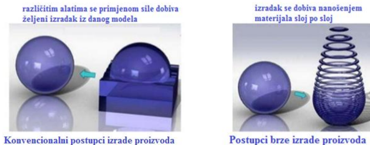
Slika 2.2. Prikaz konvencionalnih i brzih postupaka izrade proizvoda [3]
