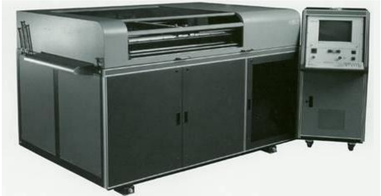
Slika 3.5. Uređaj Helisys 2030H System za postupak laminiranja
