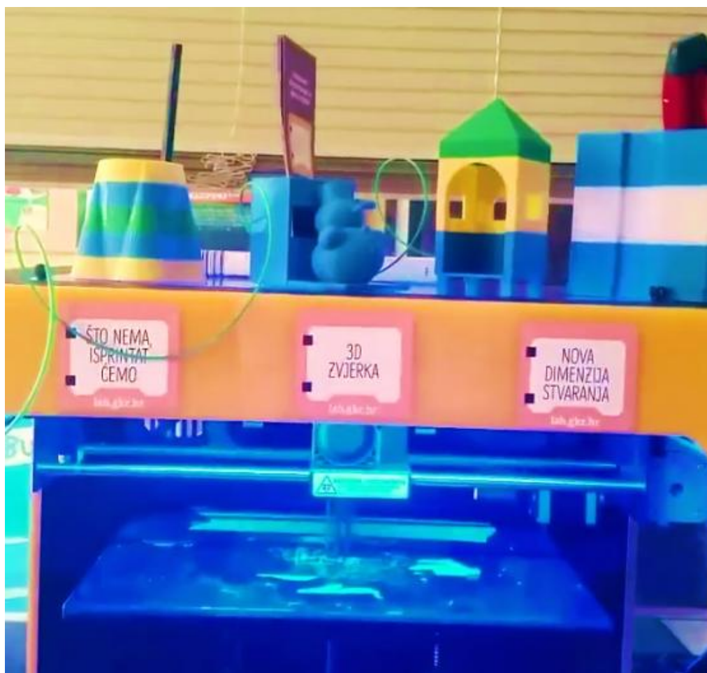
Slika 5.11. Uređaj 3D printer BQ Witbox na kojem smo izrađivali ispusnicu za pastu
