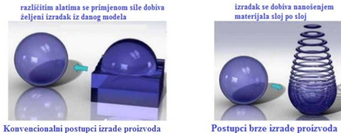
Slika 2.2. Prikaz konvencionalnih i brzih postupaka izrade proizvoda [3]
