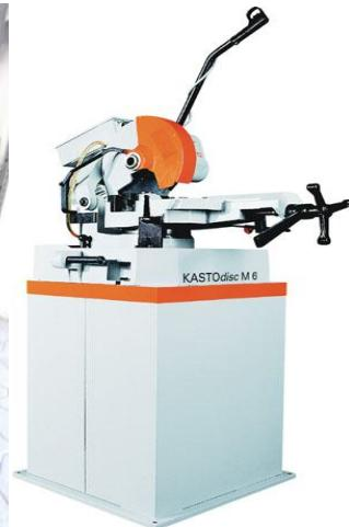
Slika 3.22. Kružna pila
