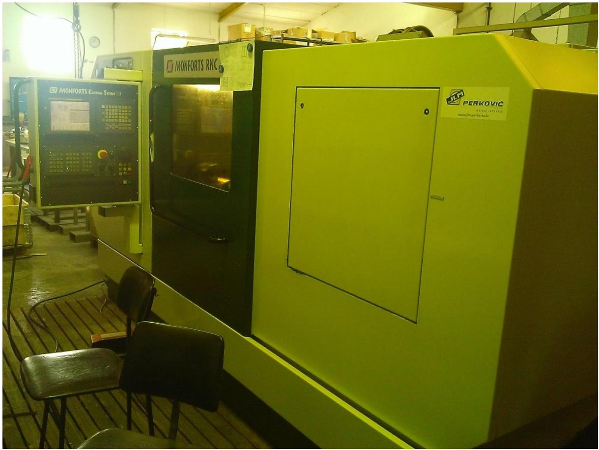
Slika 5.2. CNC tokarski stroj MONFORTS RNC 500
