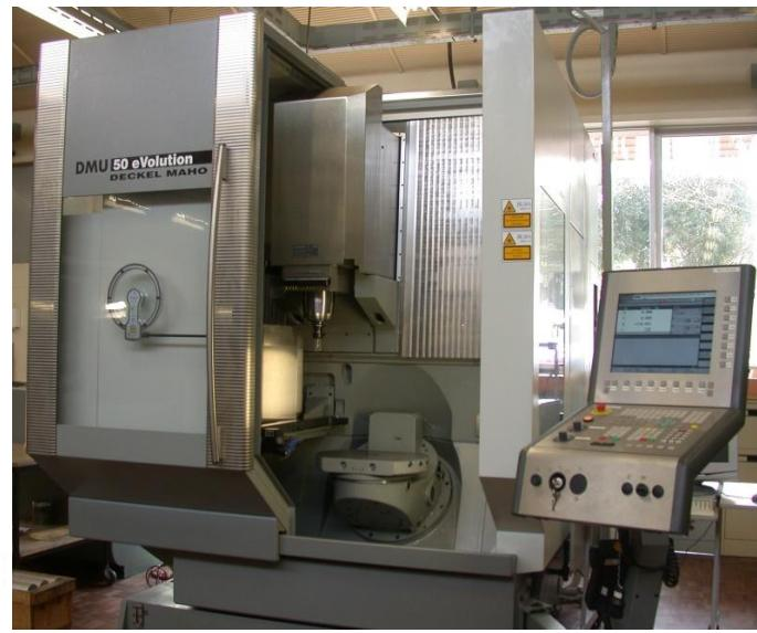
Slika 3.13. CNC glodalica
