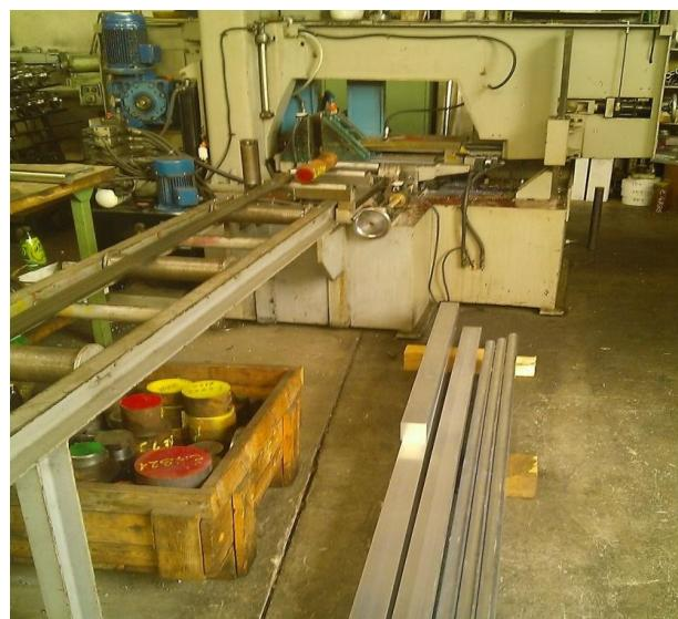
Slika 3.20. Tračna pila
