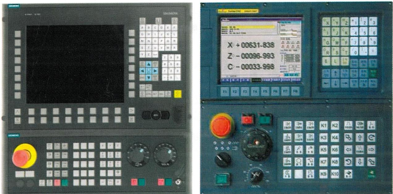
Slika 4.3. Upravljačke jedinice CNC strojeva
