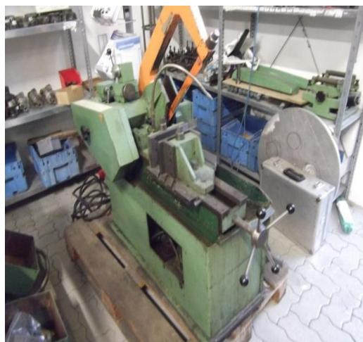
Slika 3.21. Okvirna pila
