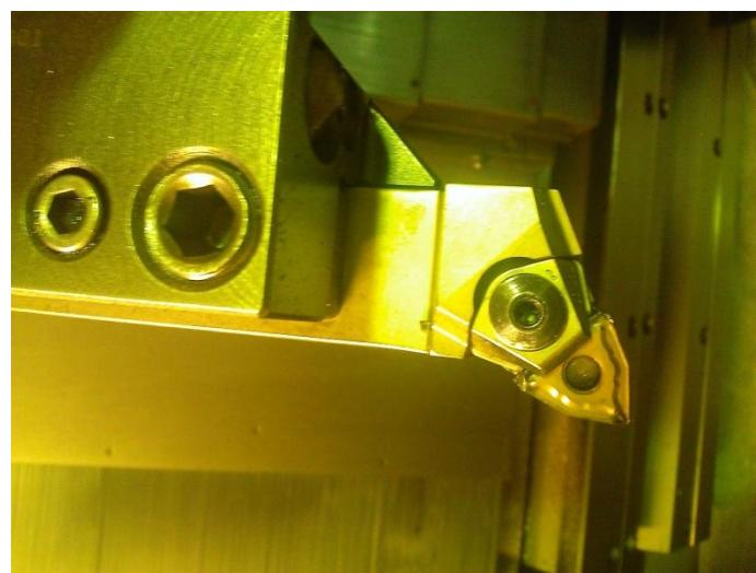
Slika 4.9. Izgled tokarskog noža MWLNR 2525M-08W
