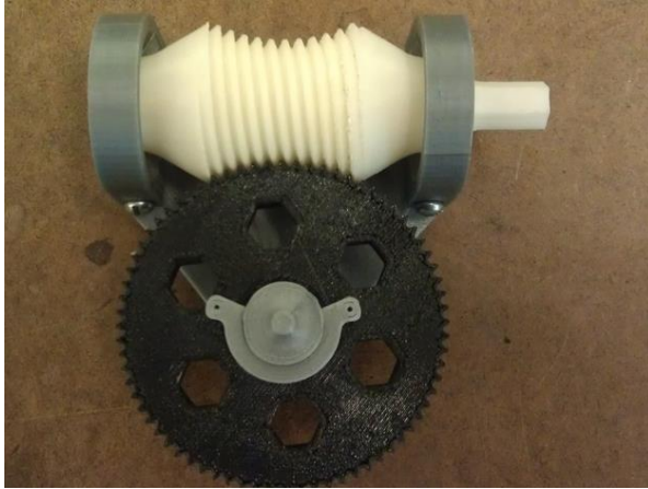
Slika 6.1. Zupčanik od akrilonitril butadiena stirena (ABS) [21]
