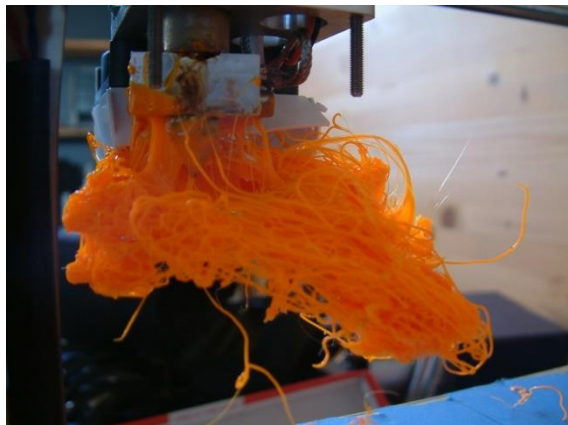
Slika 4.2. Greška prilikom printanja (1) [17]
