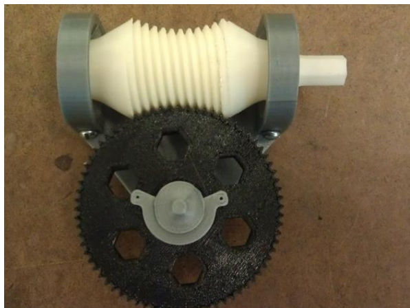
Slika 6.1. Zupčanik od akrilonitril butadiena stirena (ABS) [21]
