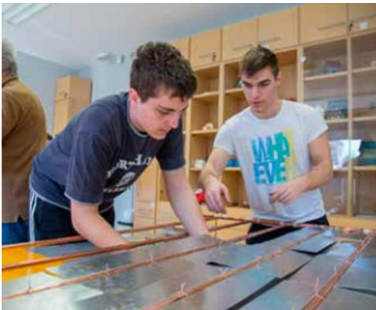
Slika 3.10. Povezivanje aluminijskih krilaca bakrenom žicom
