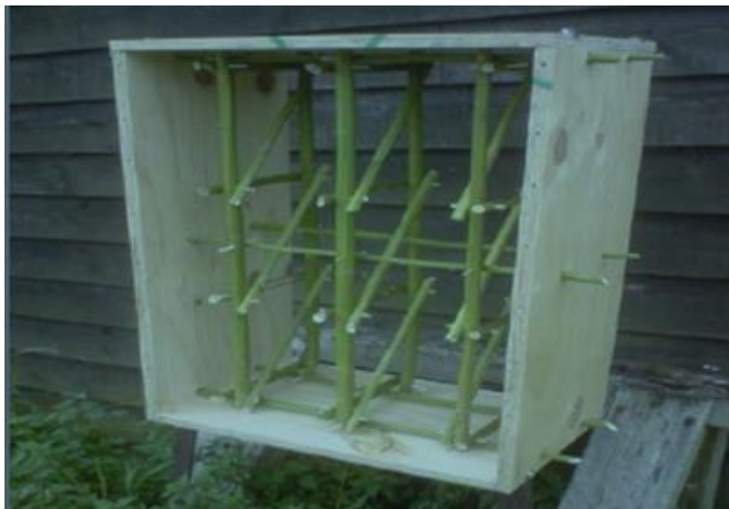
Slika 4.4. Armirani kalup za konopljin blok [12]
