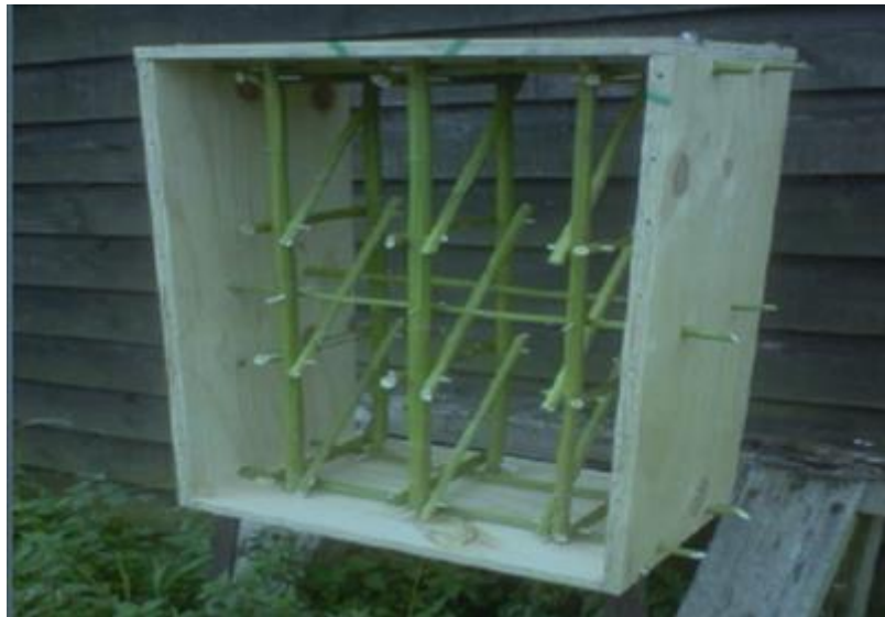
Slika 4.4. Armirani kalup za konopljin blok [12]
