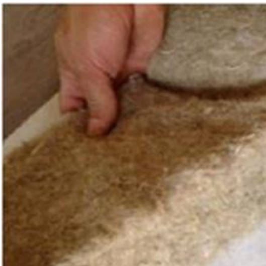
Slika 4.6. Izolacija od konoplje [13]
