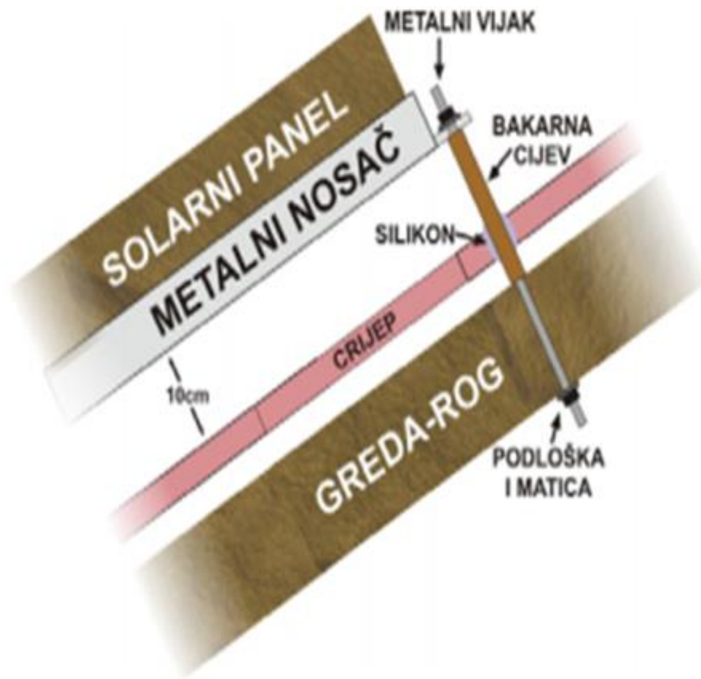
Slika 3.11. Postavljanje metalne L – konstrukcije solarnog panela/kolektora
