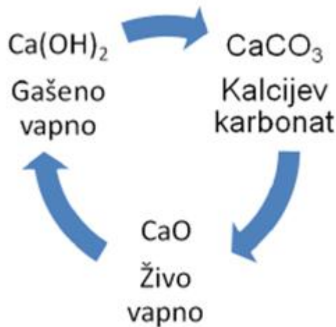
Slika 4.2. Cirkularni tok vapna
