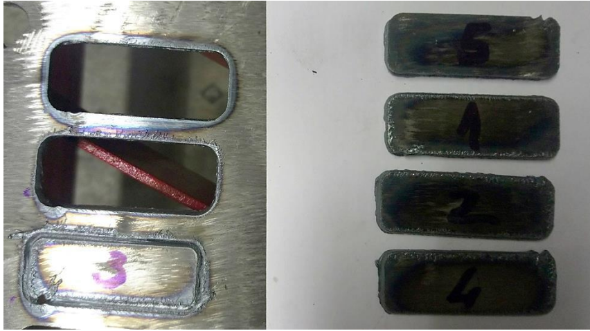
Slika 6.2. Uzorci nakon plazme rezanja
