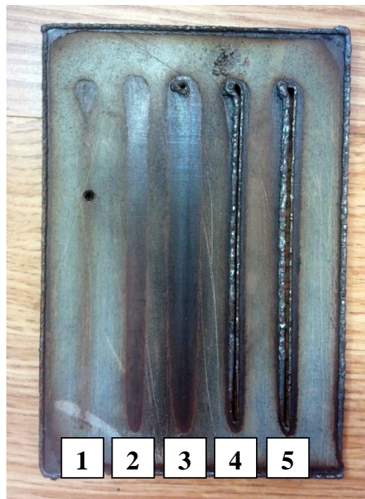
Slika 6.5. Poledina uzoraka odrezanih plazma rezanjem debljine 3 mm
