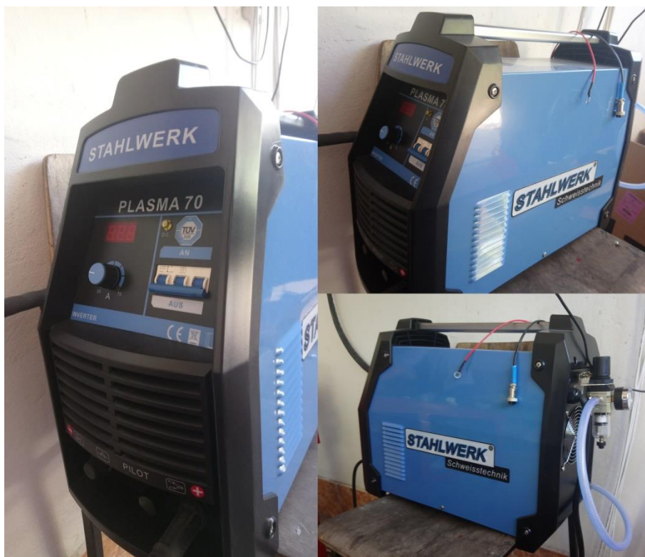
Slika 5.2. Sustav izvora za plazma rezanje
