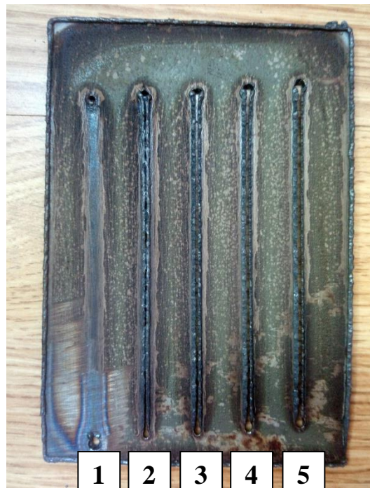
Slika 6.7. Poledina uzoraka odrezanih plazma rezanjem debljine 2 mm
