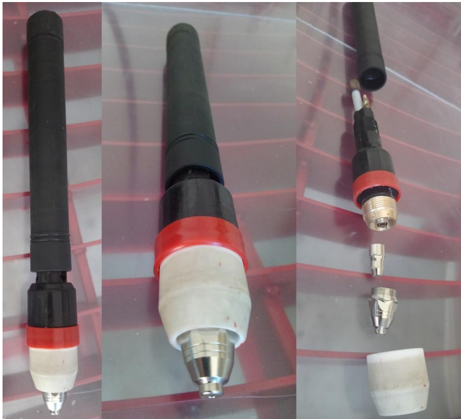
Slika 5.4. Mlaznica plazma rezača
