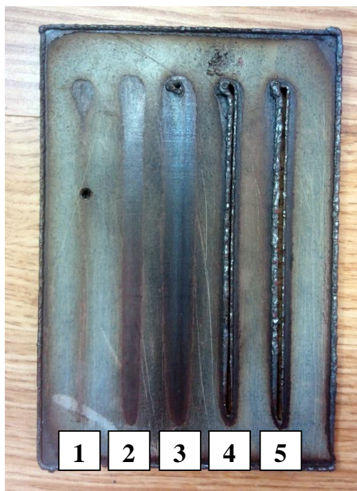
Slika 6.5. Poledina uzoraka odrezanih plazma rezanjem debljine 3 mm
