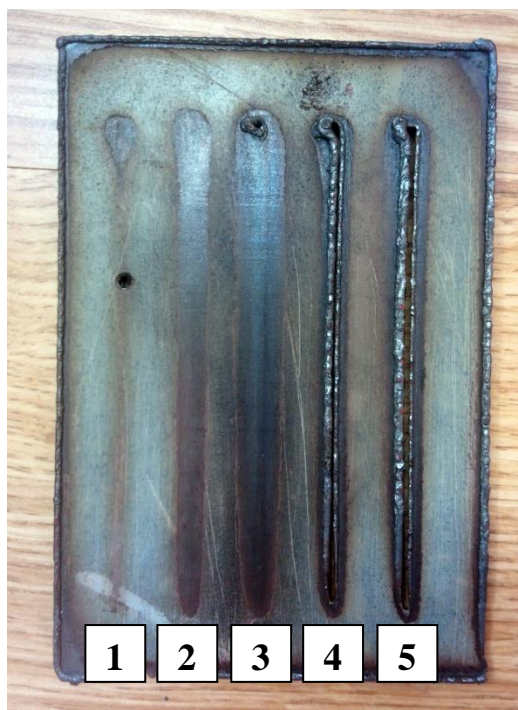
Slika 6.5. Poledina uzoraka odrezanih plazma rezanjem debljine 3 mm
