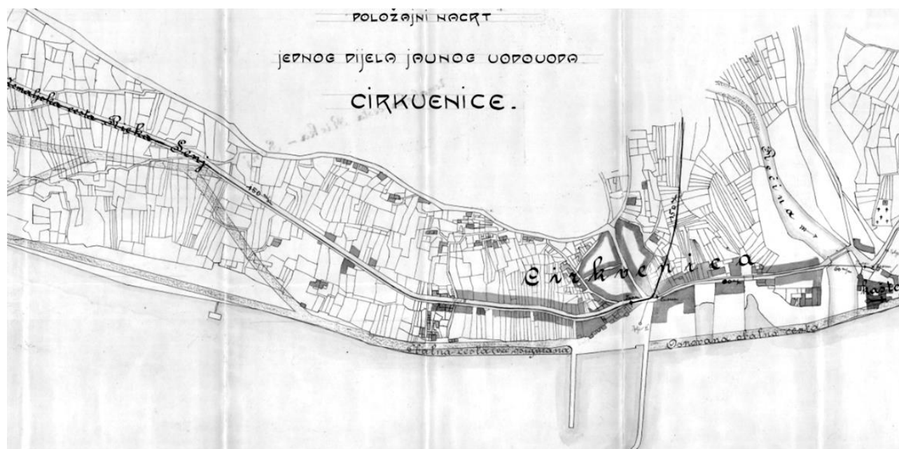
Slika 28. Položajni nacrt vodovoda , vidljivo kako cijev dolazi iz općinskog bunara te se potom grana prema Sv. Jeleni i hotelu Therapia i prema Selcu, 1908., (Izvor: Državni arhiv u Rijeci)
