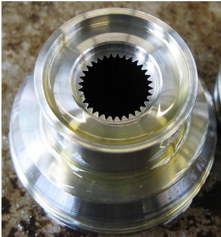
Slika 1.6. Primjer provrta napravljenog provlačenjem (žlijebni spoj) [4]
