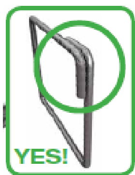
Slika 4.3. a) AFS sustav eliminira rotaciju žice oko svoje osi [12]
