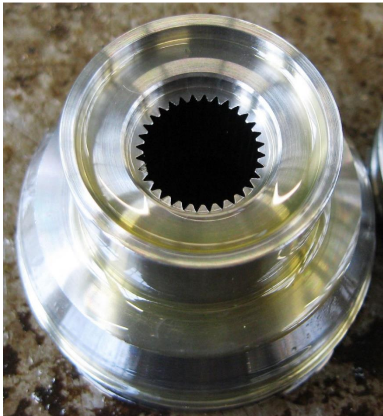
Slika 1.6. Primjer provrta napravljenog provlačenjem (žlijebni spoj) [4]
