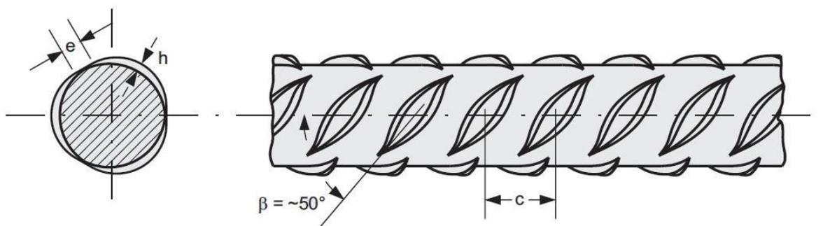
Slika 3.3. Vrijednosti geometrijskih površina rebrastog čelika [11]
