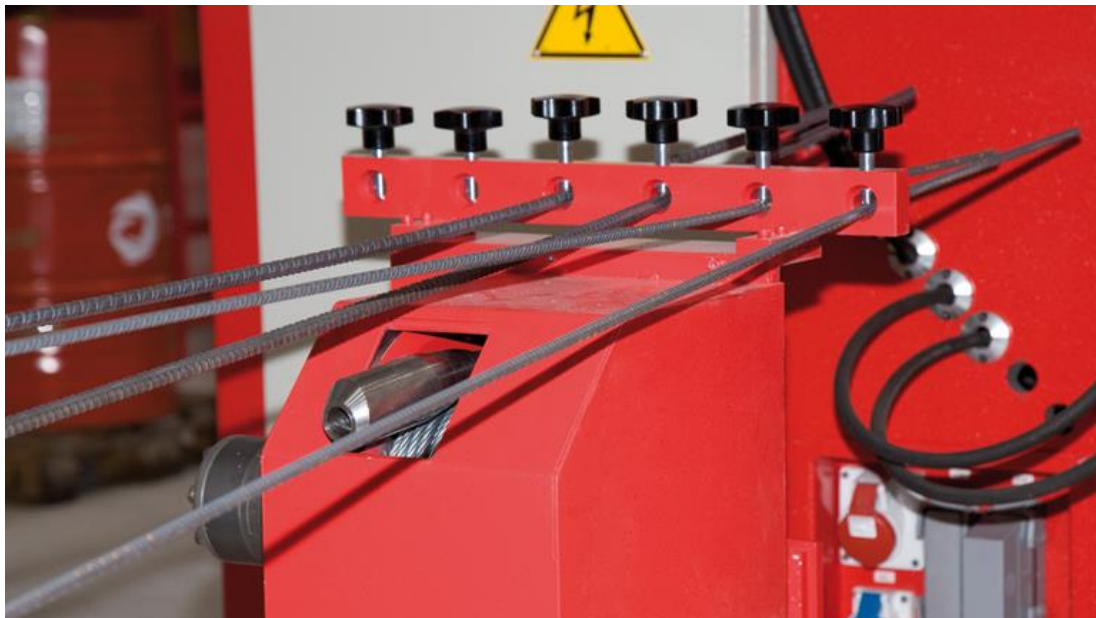
Slika 4.8. Vitlo za povlačenje žice [12]
