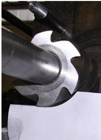
Slika 1.25. Obodno istosmjerno glodanje
