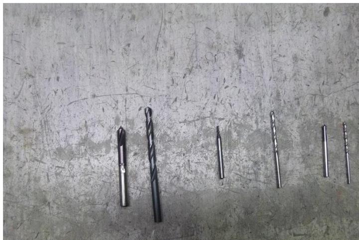
Slika 4.15. Prikaz alata za operaciju glodanja (3)
