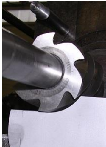
Slika 1.25. Obodno istosmjerno glodanje
