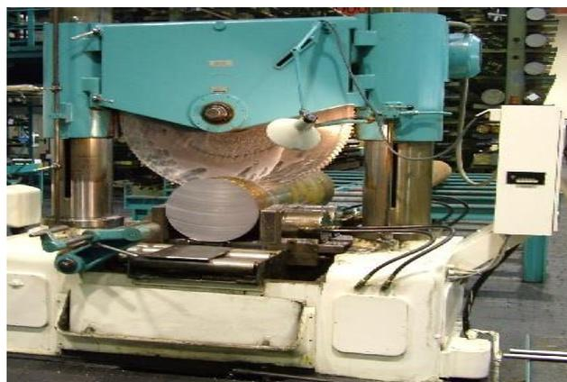
Slika 1.44. Prikaz kružnog piljenja
