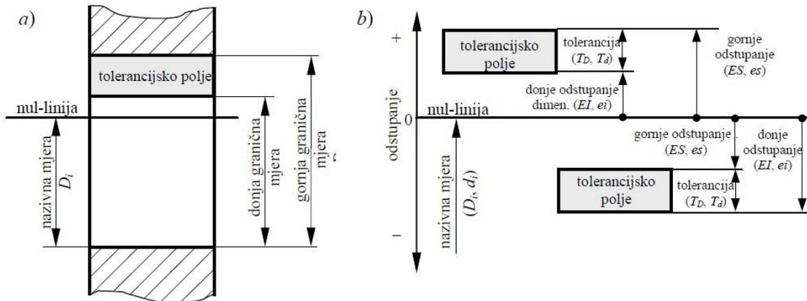
Slika 4.4. Prikaz definiranja tolerancija dužinskih mjera [17]
