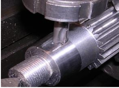
Slika 1.28. Profilno glodanje utora za klin
