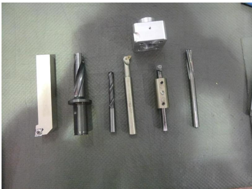
Slika 4.12. Prikaz svih potrebnih alata za izradu trolling kućišta na CNC tokarilici
