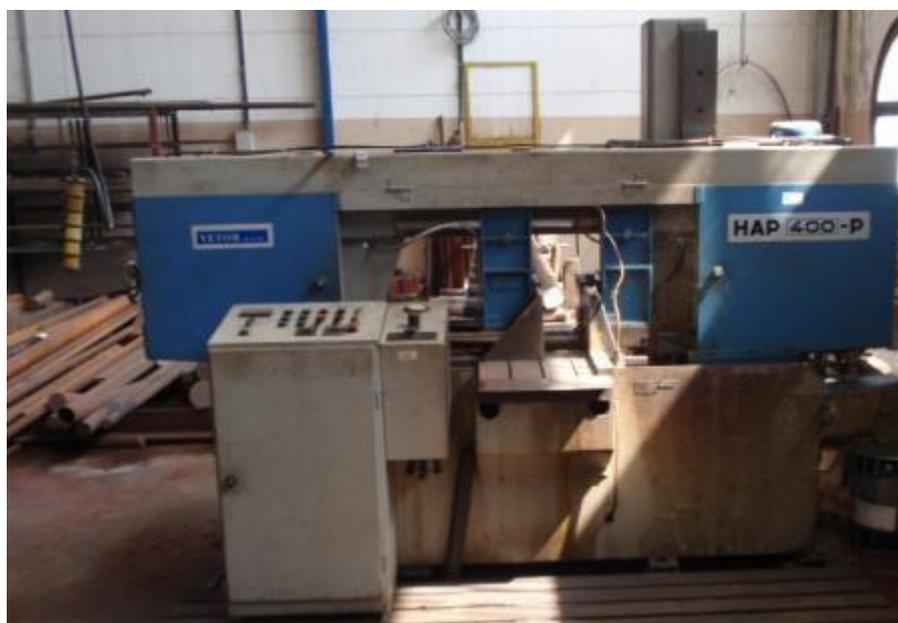
Slika 5.1. Prikaz tračne pile Vetor HAP 400 – P
