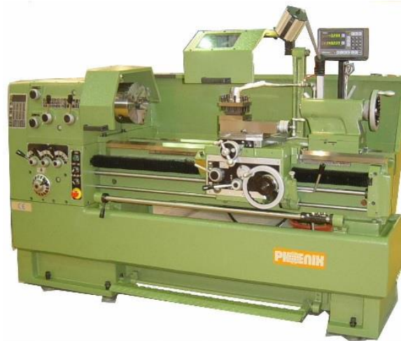
Slika 1.23. Univerzalni tokarski stroj
