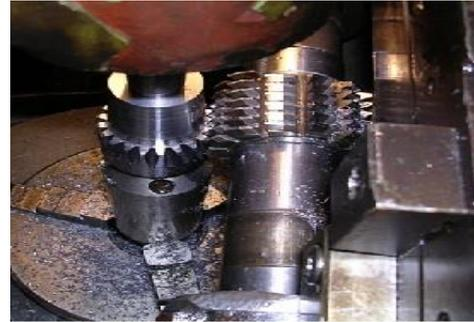
Slika 1.29. Odvalno glodanje zupčanika
