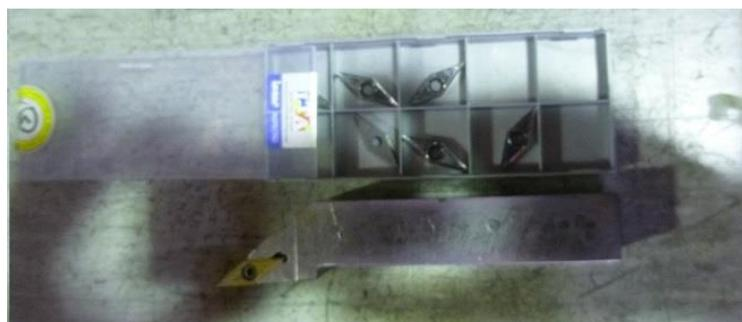
Slika 1.15. Prikaz alata za finu obradu oznake SVJBR 2525M – 16 uz odgovarajuće rezne pločice u tvrtki „JLM Perković“
