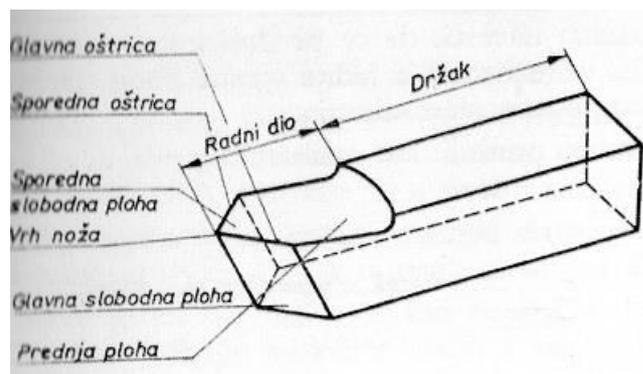
Slika 1.10. Površine tokarskog noža [10]
