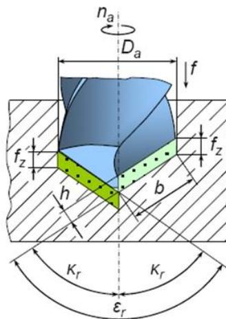
Slika 1.53. Prikaz parametara kod bušenja
