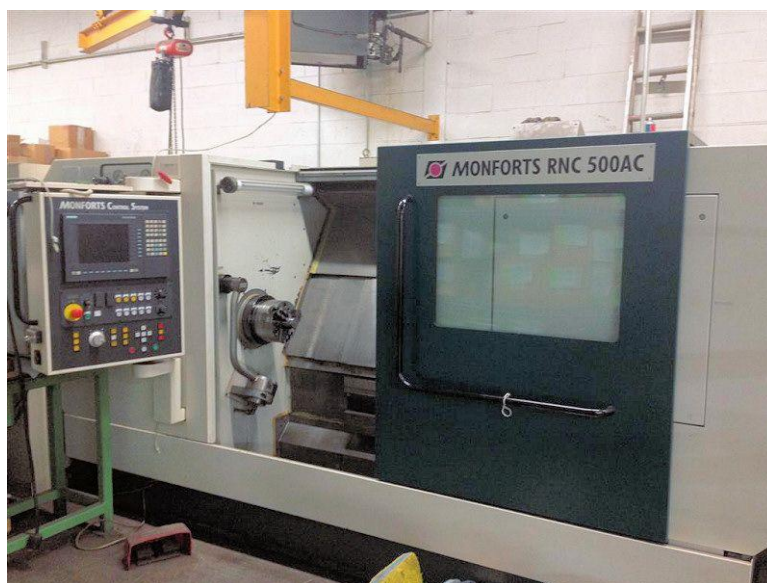
Slika 5.3. Prikaz tokarilice Monforts RNC 500-AC s Fanuk kontrolom
