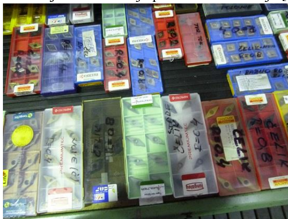
Slika 1.18. Primjer označavanja pločica za tokarenje [8]
