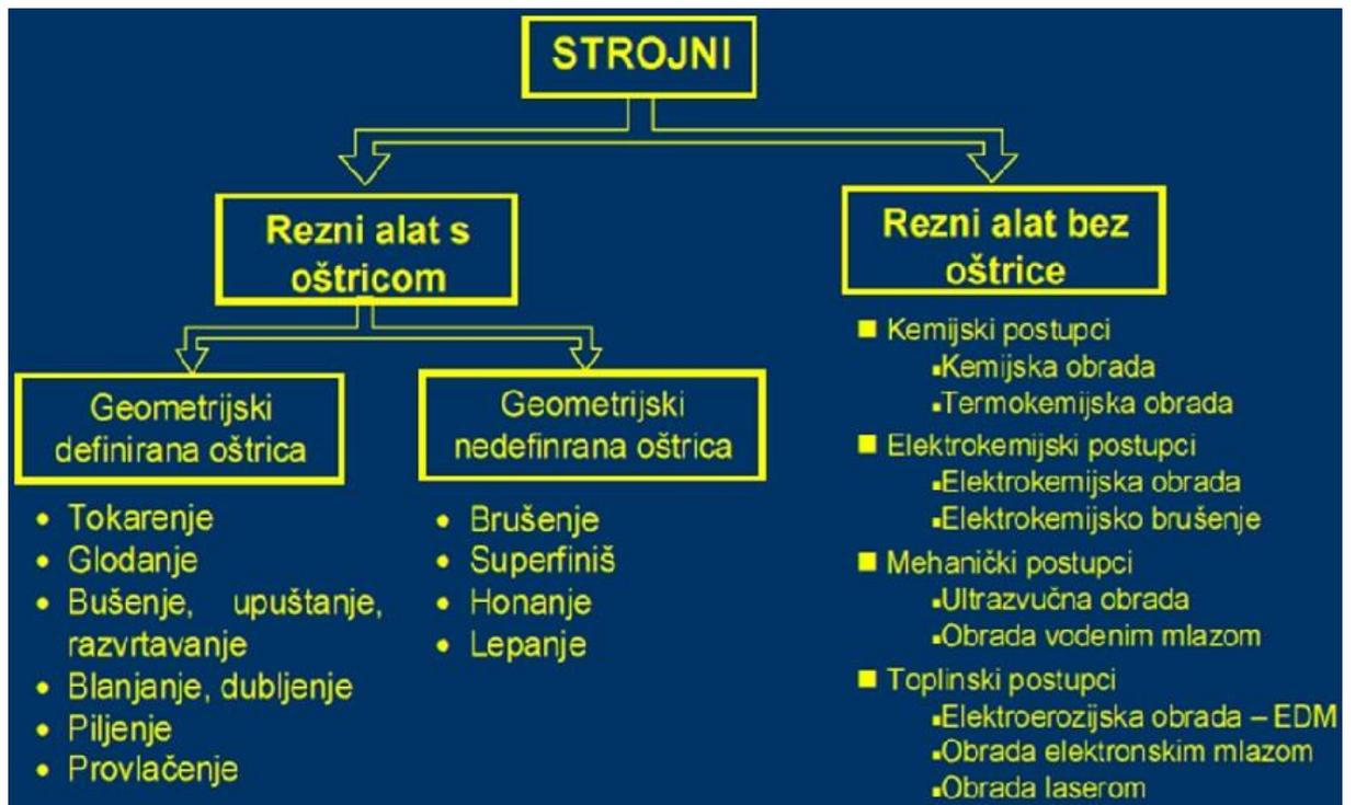
Slika 1.2 Prikaz postupaka obrade materijala s odvajanjem čestica [8]
