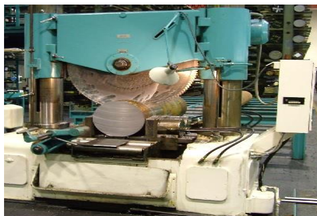
Slika 1.44. Prikaz kružnog piljenja
