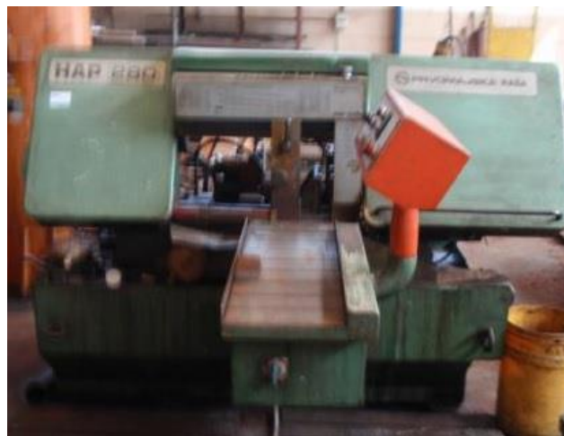
Slika 1.43. Prikaz tračnog piljenja
