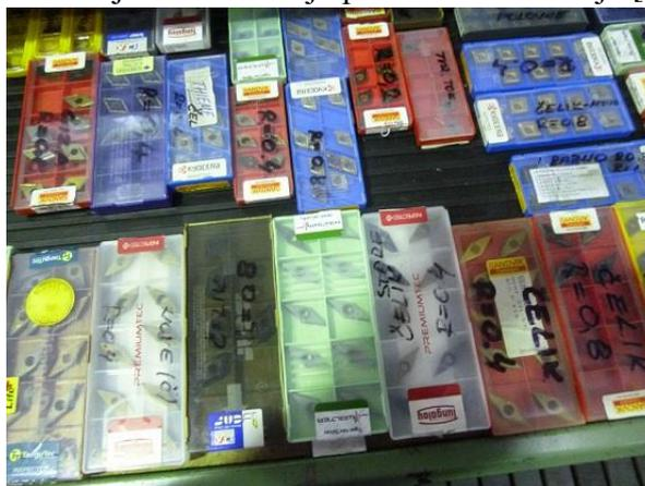
Slika 1.19. Razne pločice za tokarenje u tvrtki „JLM Perković“
