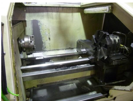
Slika 5.2. Prikaz radnog dijela stroja Weipert Voest Alpine WNE 490
