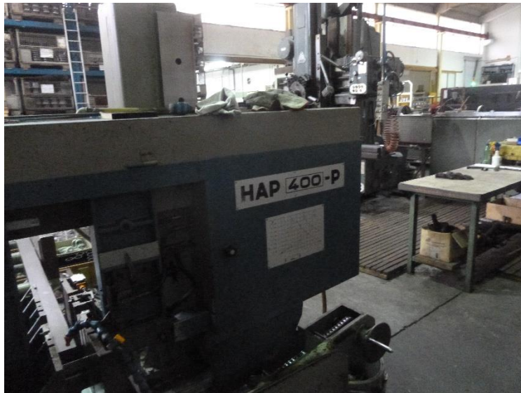
Slika 4.11. Prikaz horizontalne tračne pile u tvrtki „JLM Perković“
