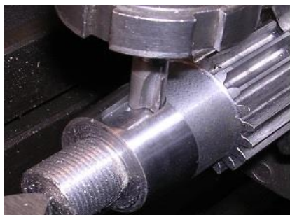
Slika 1.28. Profilno glodanje utora za klin
