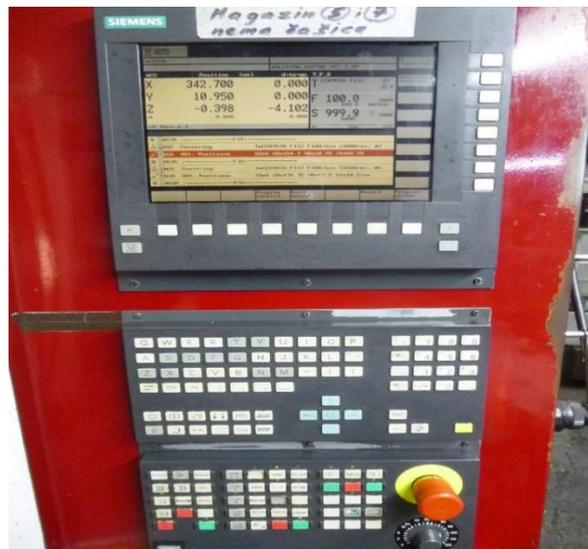
Slika 5.6. Prikaz Siemens upravljačke ploče na Schmid VMC 800 obradnom centru
