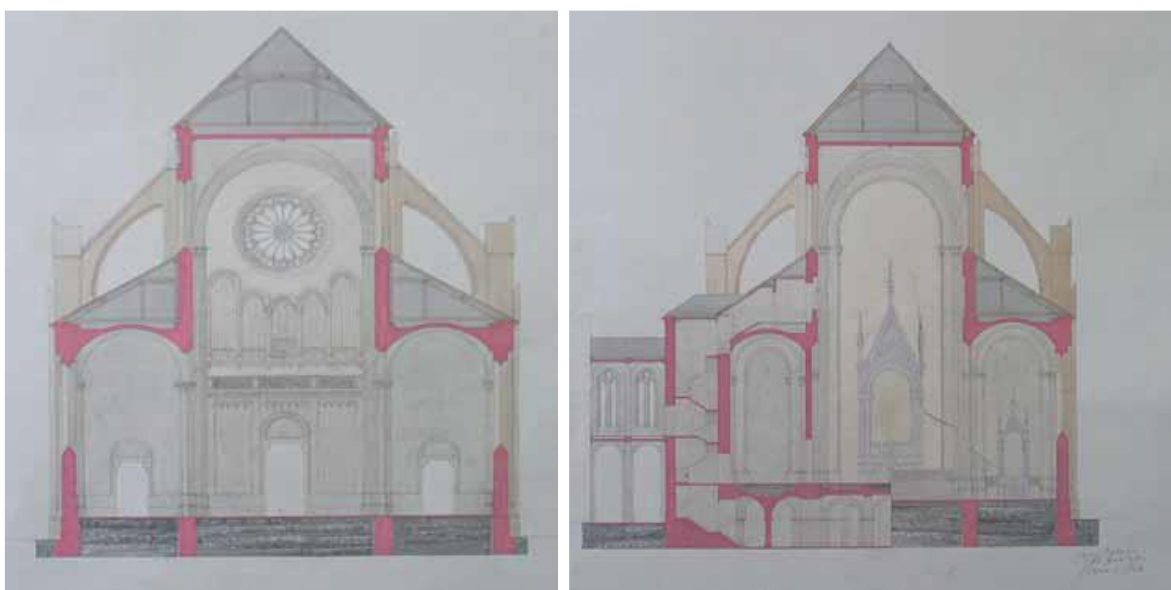
Slika 4. Poprečni presjek pogled prema koru
