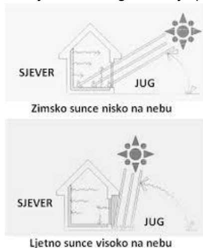
Sl.1.1. Primjer pasivnog korištenja Sunčevog zračenja [1]
