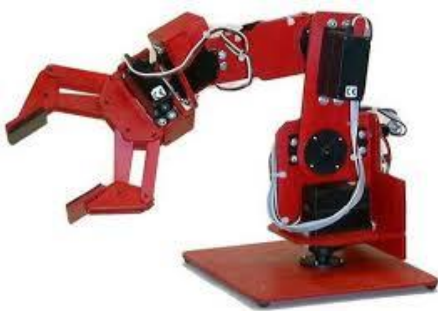
Slika 3.1 – Mehanička struktura robotske ruke s aktuatorima
