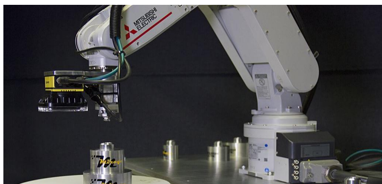
Slika 3.7 – Robotska ruka na pneumatski pogon
