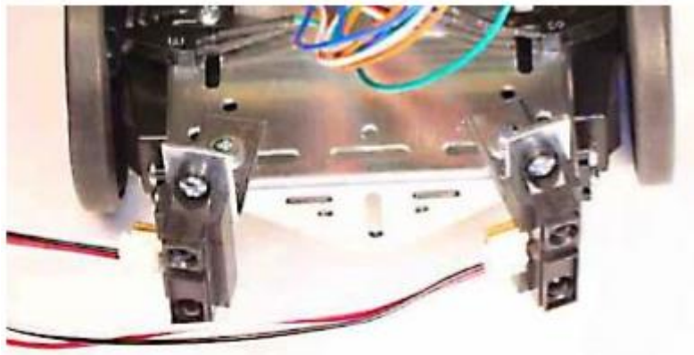
Slika 3.6 b) Prikaz robota nakon montaže senzora udaljenosti
