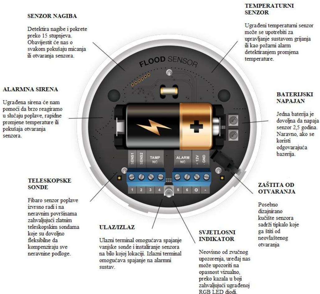
Slika 21. Unutrašnjost Fibaro senzora poplave
