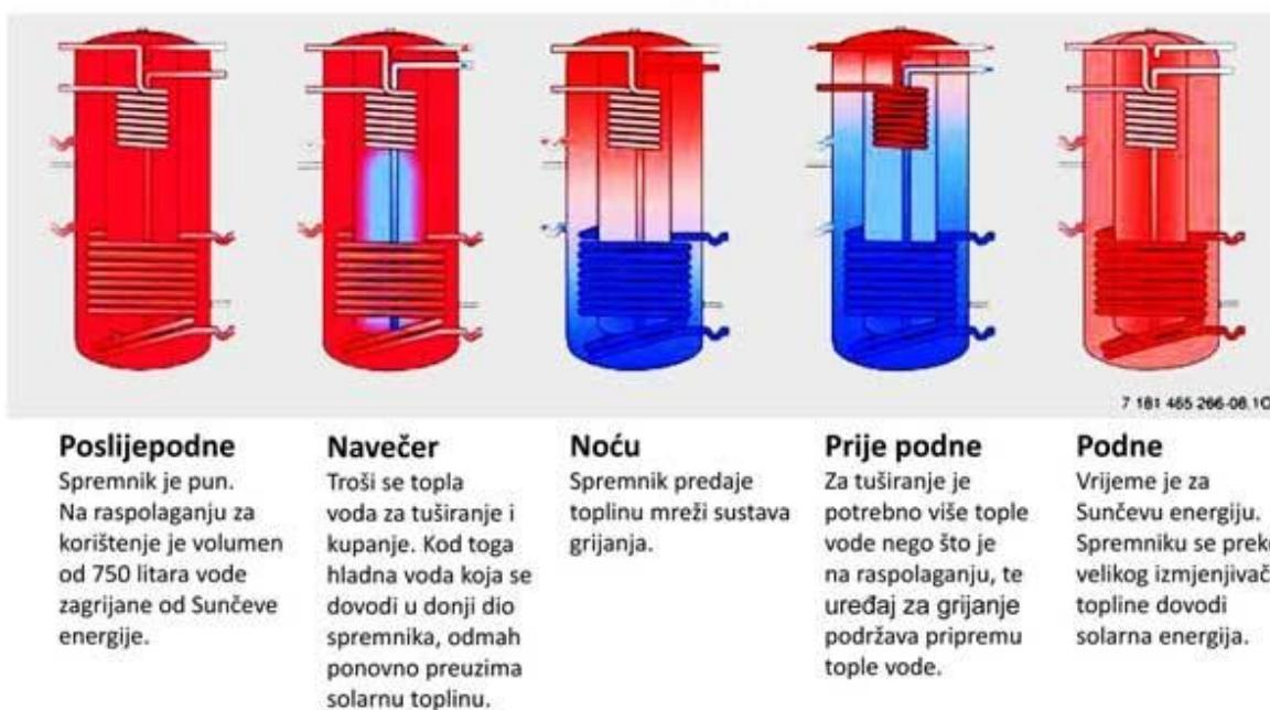
Slika 12. Princip rada BOSH solarnog kombiniranog spremnika za toplu vodu i podršku sustava grijanja
