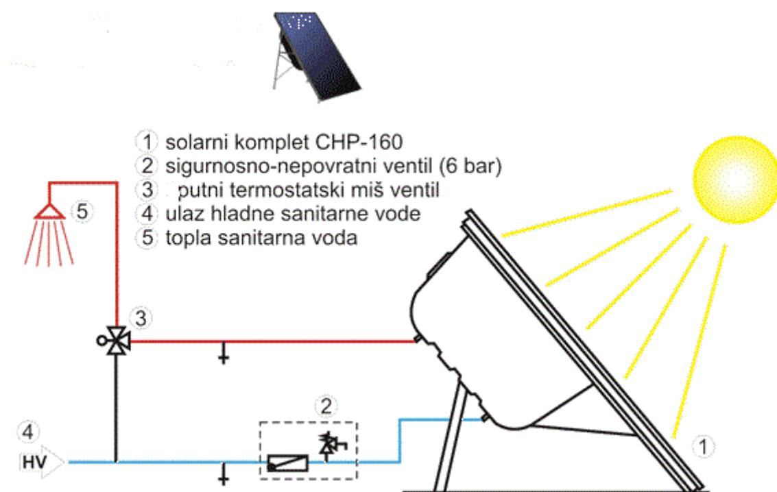
Slika 13. Solarni komplet
