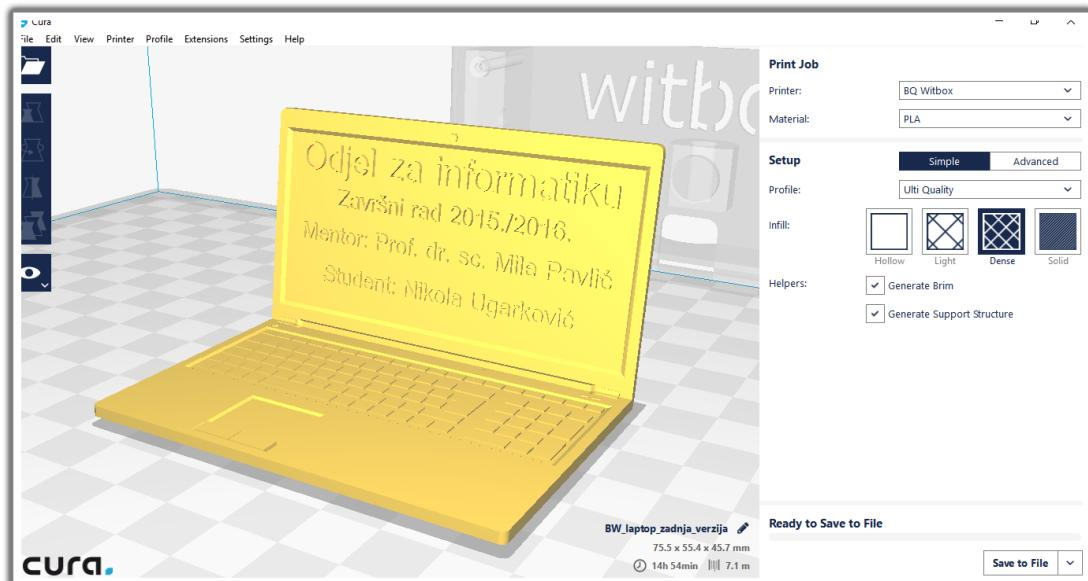
Slika 39. Priprema 3D modela za printanje u CURI
