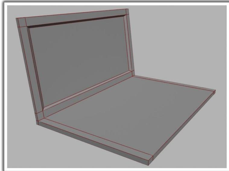
Slika 32. Udubljenje za zaslon napravljeno pomoću extrude alata
