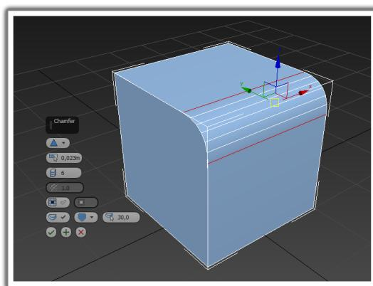
Slika 12. Chamfer ruba
