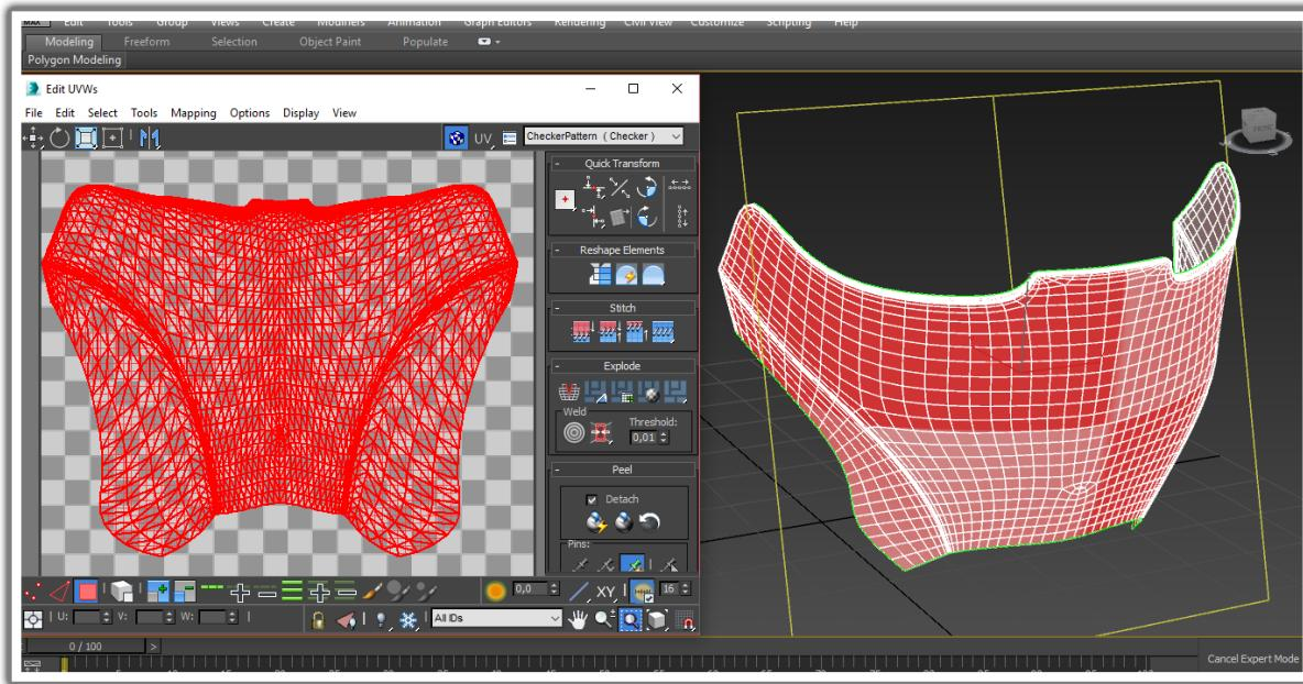
Slika 17. Postupak cilindričnog UV mapiranja 3D objekta
