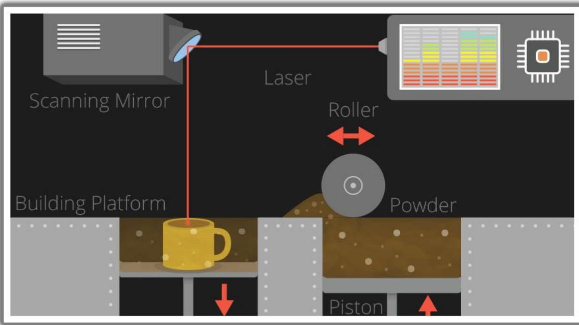
Slika 22. Princip rada selektivnog laserskog sinteriranja
