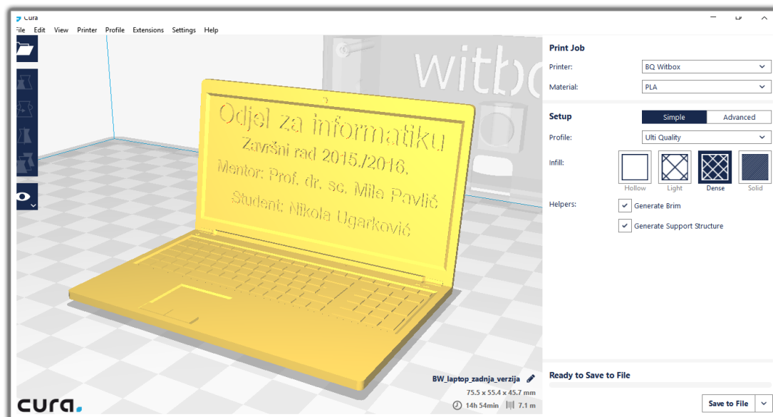
Slika 39. Priprema 3D modela za printanje u CURI
