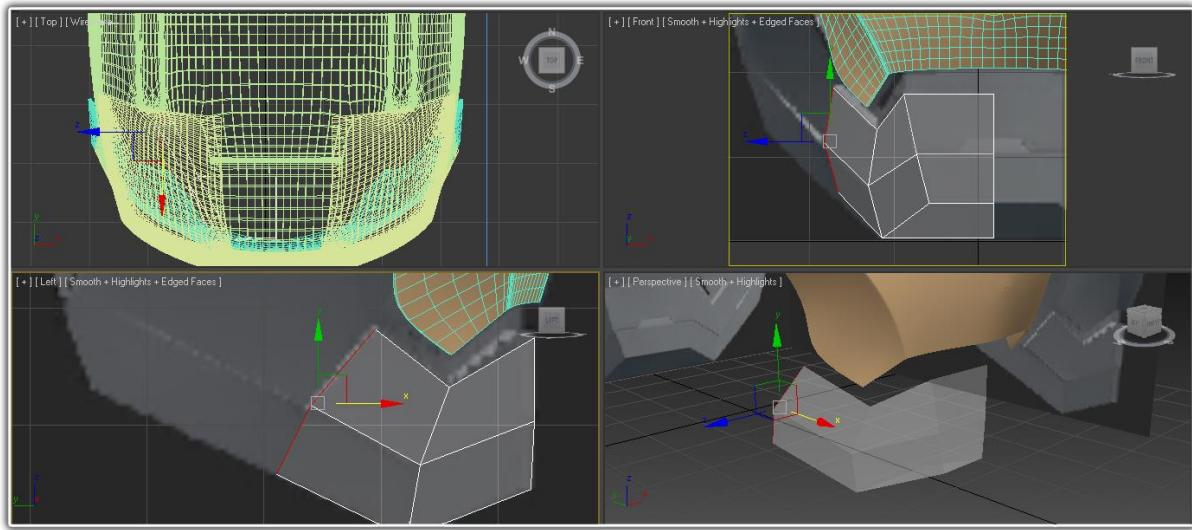
Slika 14. Postupak oblikovanja poligona prema pozadinskoj slici
