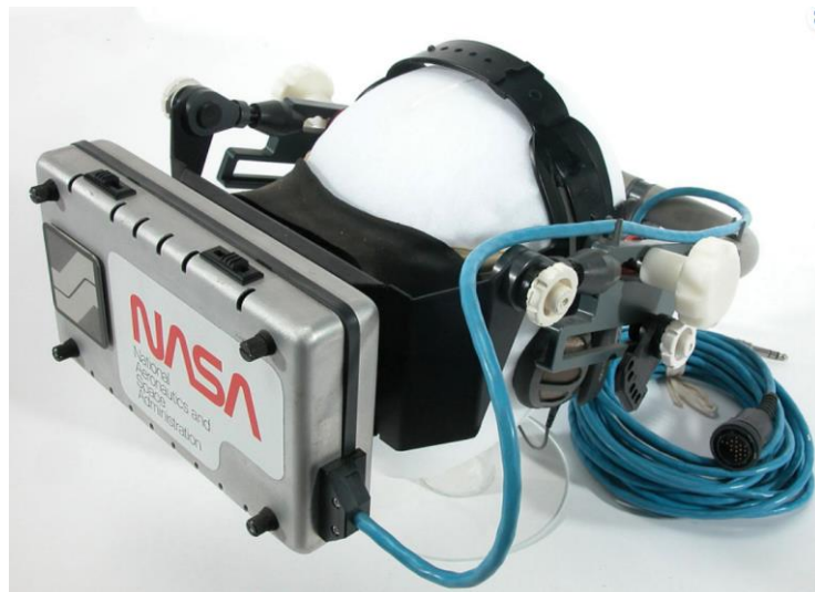
Slika 3: Prve naočale za virtualnu stvarnost korištene za obuku astronauta (Preuzeto s: National Air and Space Museum)
