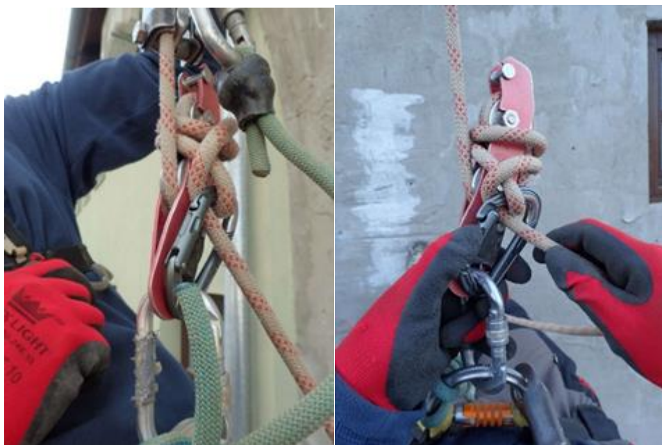
Slika 9: Problem razblokiranja užeta tijekom korištenja dodatnog karabinera na karabineru simple descendera
