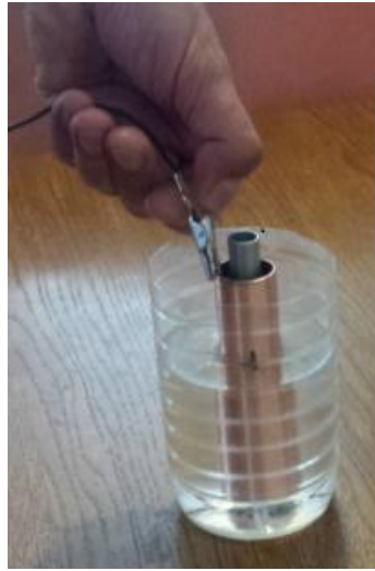
Slika 5.1.8 Spajanje sa hvataljkama
