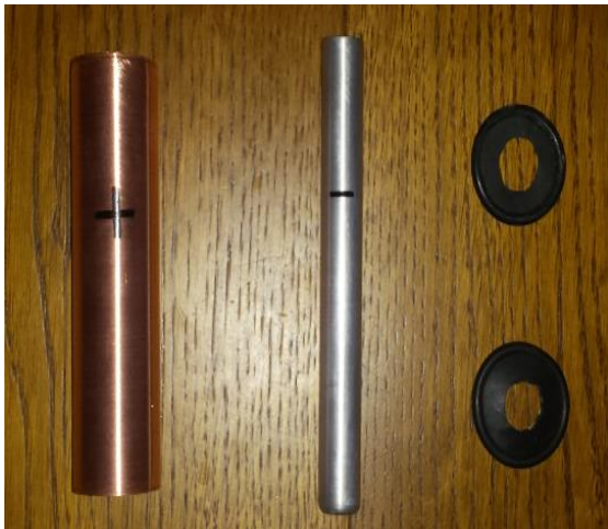
Slika 5.1.1 Bakar (Cu) i aluminij (Al) i brtve
