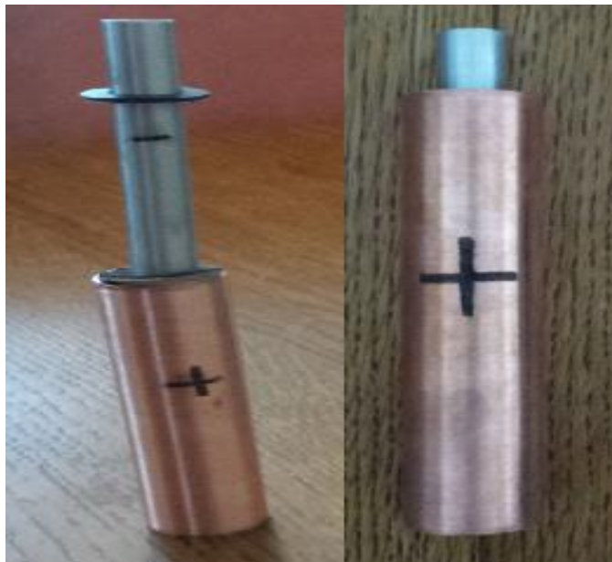
Slika 5.1.3 stavljanje aluminijske cijevi u bakrenu
