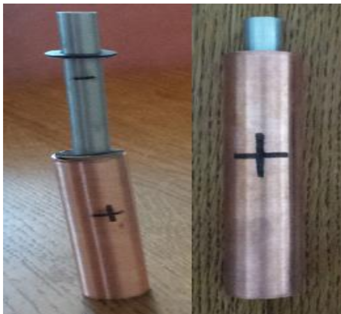
Slika 5.1.3 stavljanje aluminijske cijevi u bakrenu
