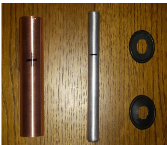
Slika 5.1.1 Bakar (Cu) i aluminij (Al) i brtve
