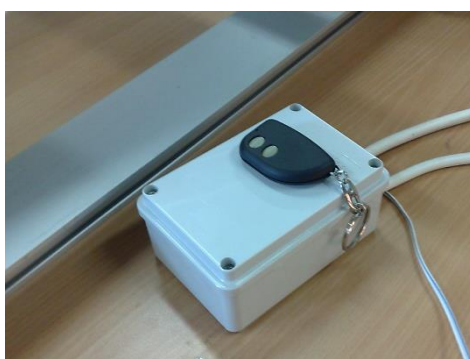
Slika 4.3. Sustav za daljinsko upravljanje
