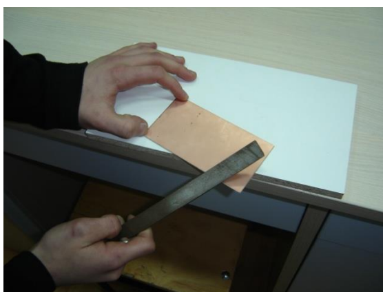
Slika 4.7. Uređivanje bridova pločice.
