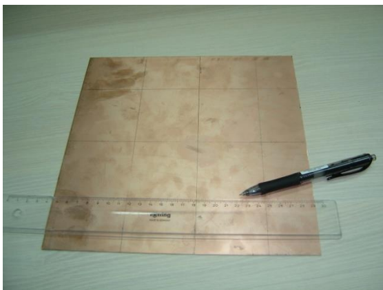
Slika 4.5. Ocrtavanje gabarita pločice.
