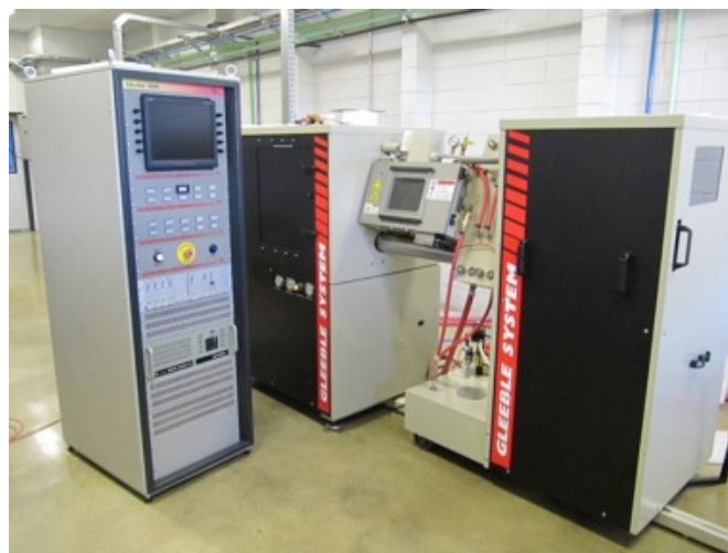
Slika 2.9. Simulator toplinskog ciklusa Gleeble
