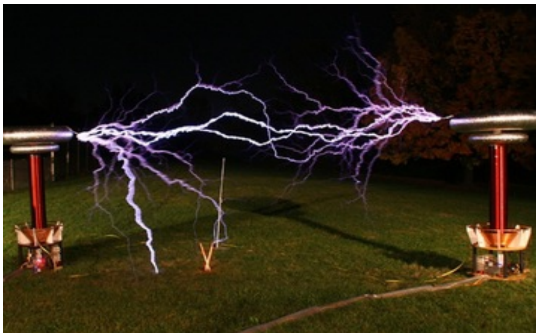
Slika 4.2.1.2 Dva Teslina transformatora s usmjerenjem, u radu
