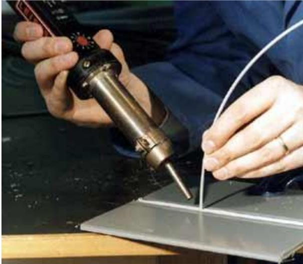
Slika 3.4. Prikaz zavarivanja polimernog materijala vrućim plinom [6]
