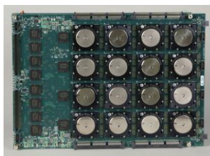
Slika 6.1. IBM-ova ploča sa 16 neuromorfih čipova
