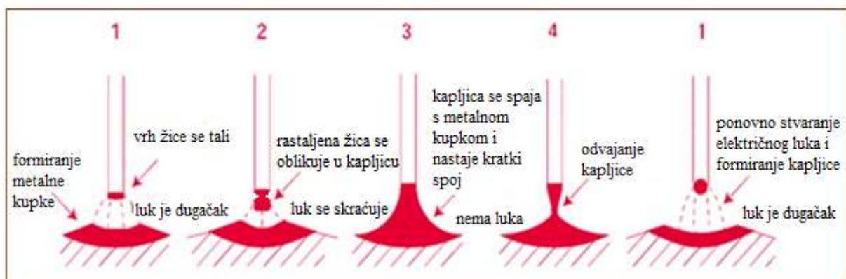
Slika 2.21. Shematski prikaz MAG zavarivanja u kratkom spoju [9]
