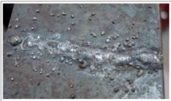
Slika 2.32. Zavar izveden globularnim režimom rada [9]
