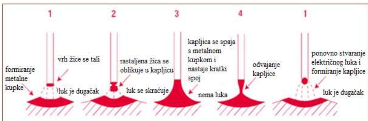
Slika 2.21. Shematski prikaz MAG zavarivanja u kratkom spoju [9]
