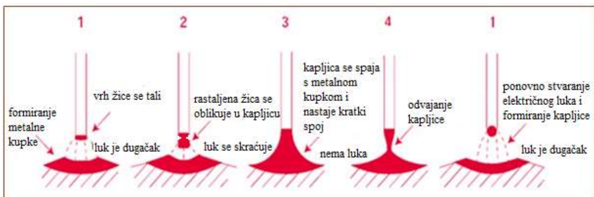
Slika 2.21. Shematski prikaz MAG zavarivanja u kratkom spoju [9]
