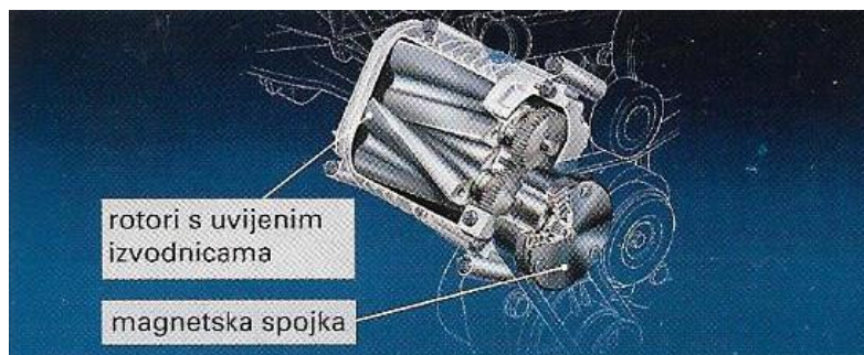
Slika 2.16. Rootov kompresor s magnetskom spojkom [2]
