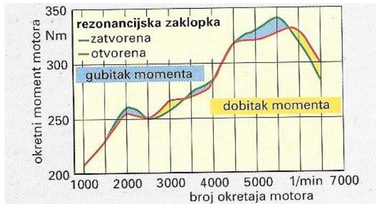
Dijagram 2.3. Promjena okretnog momenta uključivanjem rezonantne cijevi [2]
