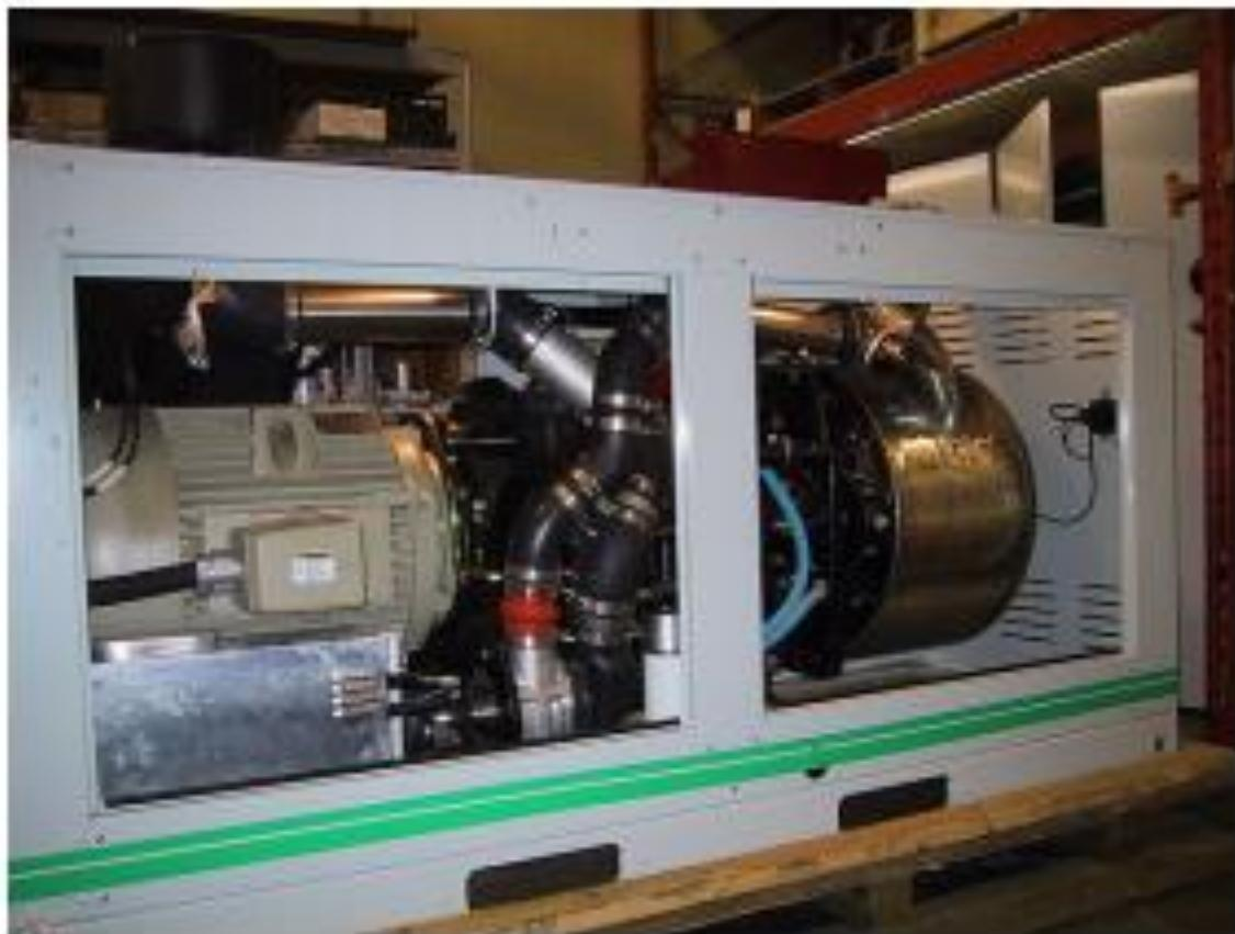
Slika 27. Stirling motor od 55 kW [42]
