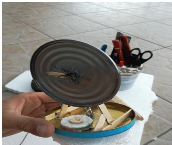
Slika 33. Prikaz zamašnjaka LTD Stirling motora
