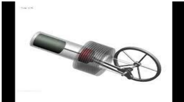
Slika 12. Beta Stirling motor [27]
