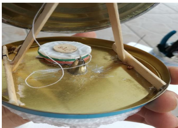
Slika 31. Prikaz klipa LTD Stirling motora
