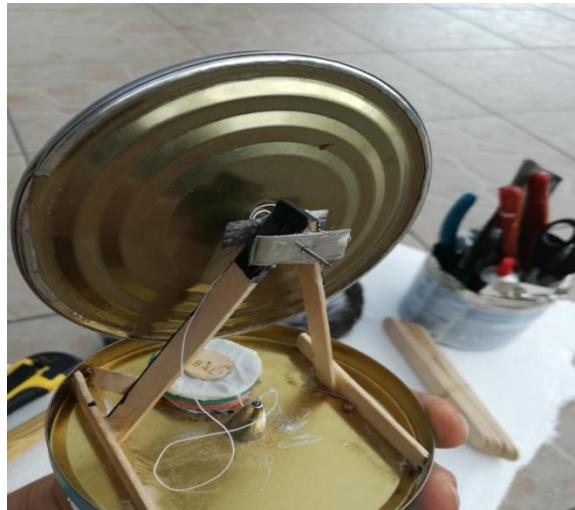
Slika 32. Prikaz okvira LTD Stirling motora
