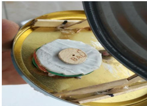
Slika 28. Prikaz cilindra LTD Stirling motora
