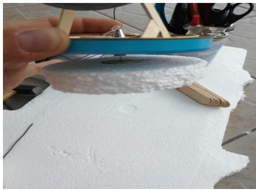
Slika 29. Potiskivač LTD Stirling motora
