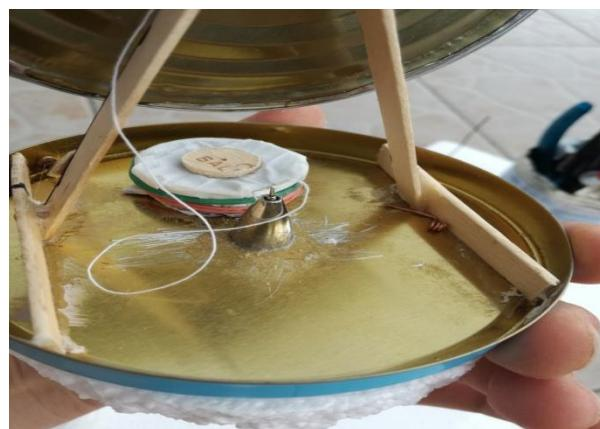
Slika 31. Prikaz klipa LTD Stirling motora
