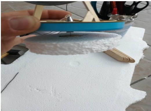
Slika 29. Potiskivač LTD Stirling motora
