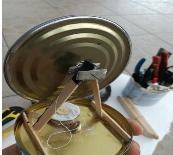
Slika 32. Prikaz okvira LTD Stirling motora
