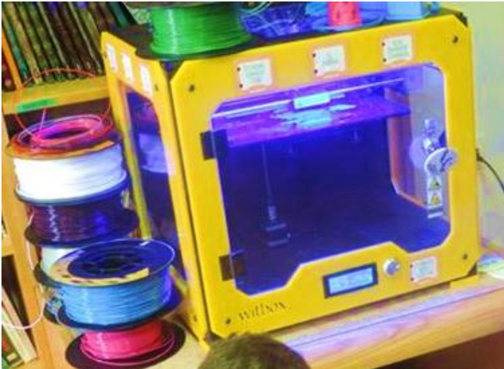
Slika 5.9. Uređaj 3D printer BQ Witbox na kojem smo izrađivali ispusnicu za pastu
