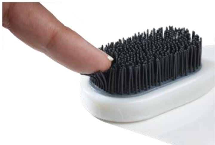
Slika 3.13. Materijali sličnih karakteristika kao elastomer (tango materijali) [21]
