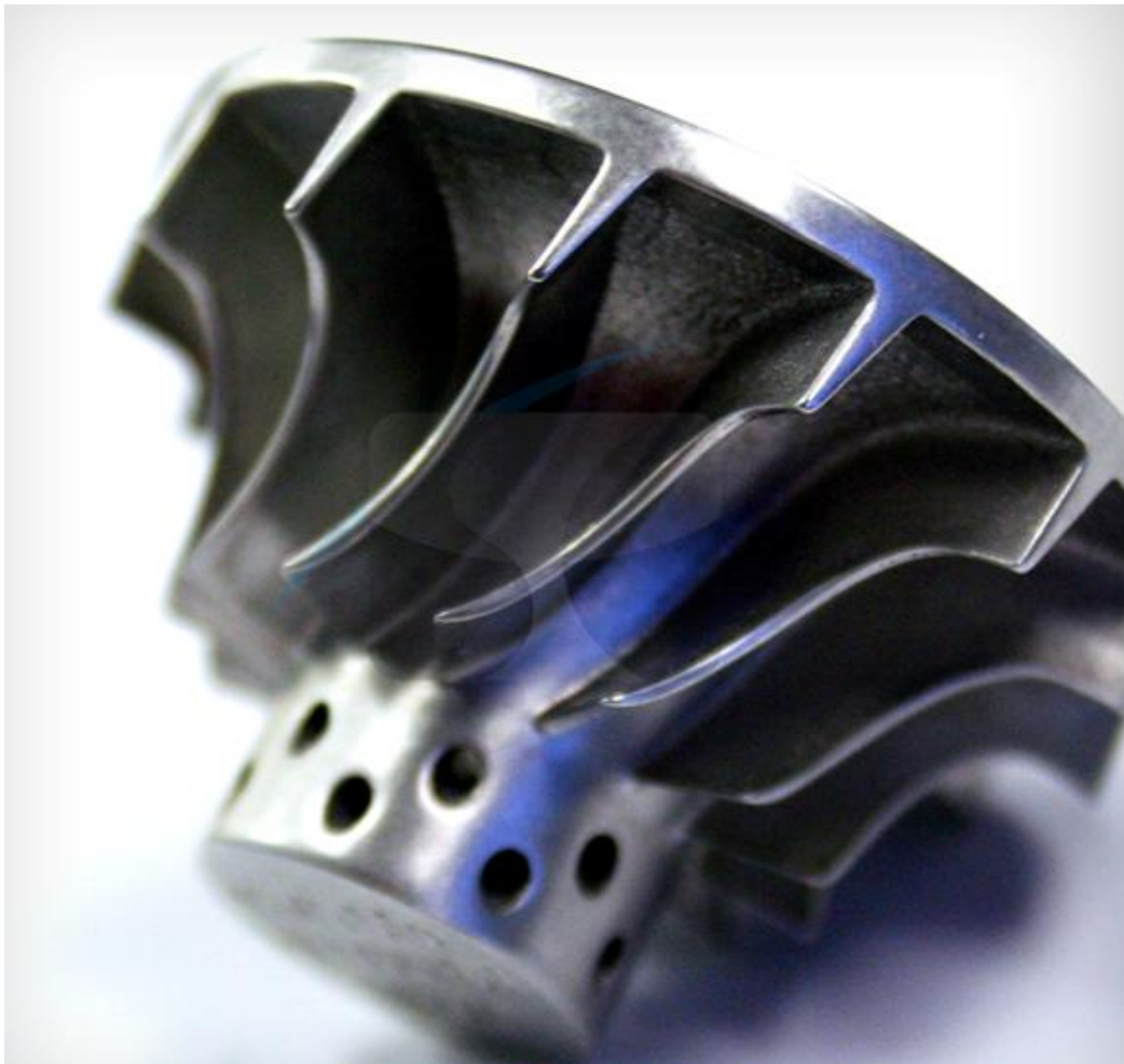
Slika 3.21. Primjer proizvoda napravljen selektivnim laserskim srašćivanjem[32]
