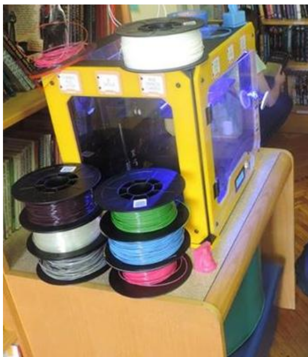
Slika 5.10. Uređaj 3D printer BQ Witbox na kojem smo izrađivali ispusnicu za pastu
