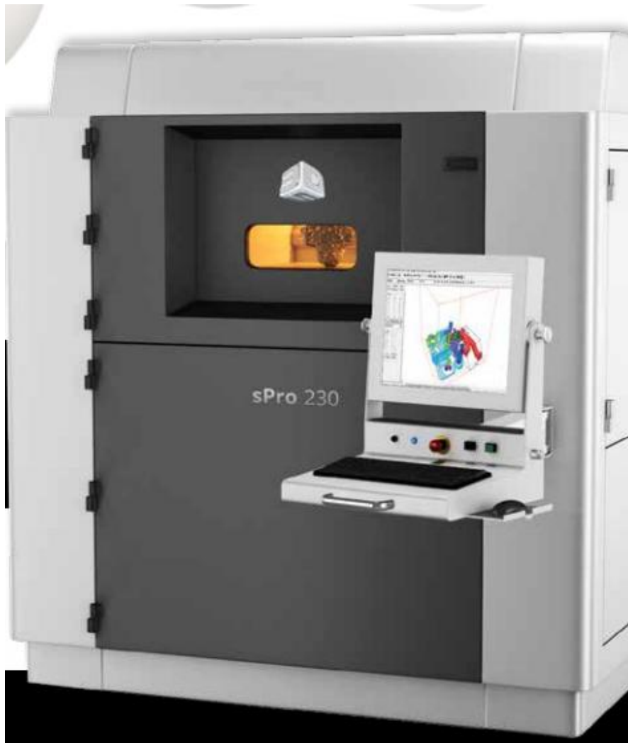
Slika 3.19. Uređaj za selektivno lasersko srašćivanje [29]
