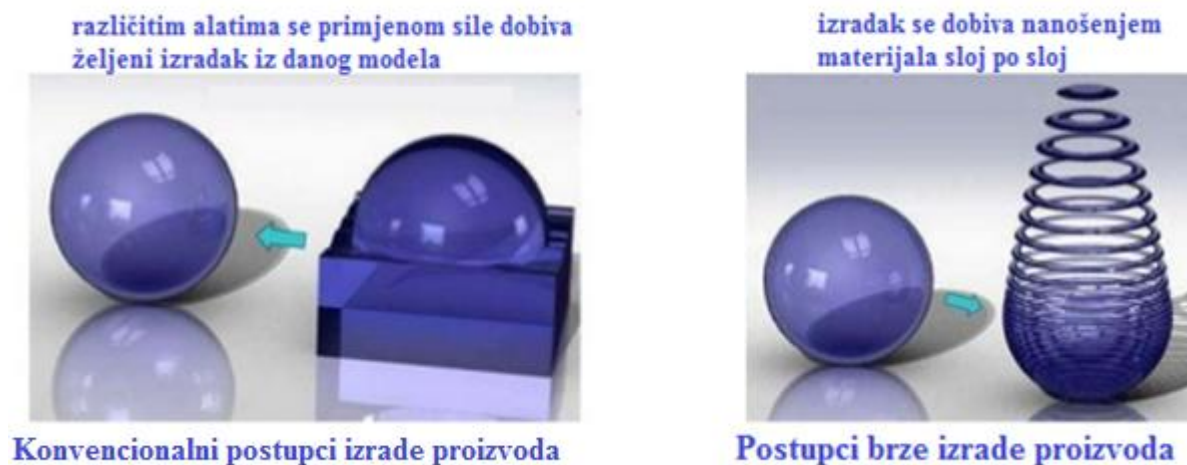
Slika 2.2. Prikaz konvencionalnih i brzih postupaka izrade proizvoda [3]
