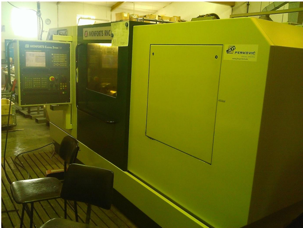
Slika 5.2. CNC tokarski stroj MONFORTS RNC 500
