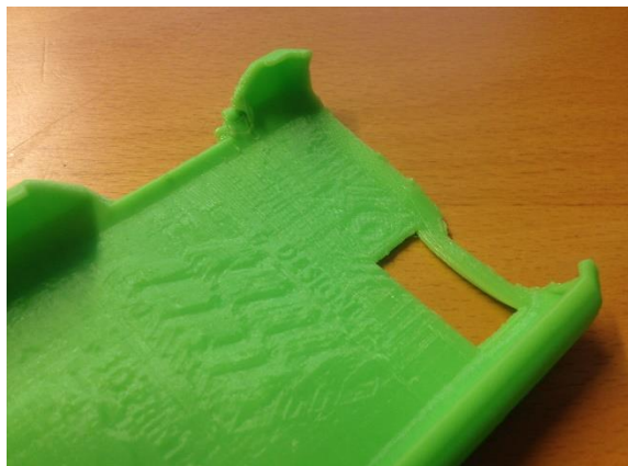
Slika 4.3. Greška prilikom printanja (2) [17]
