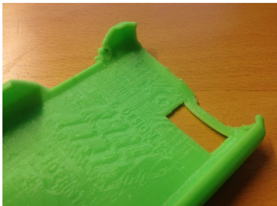
Slika 4.3. Greška prilikom printanja (2) [17]
