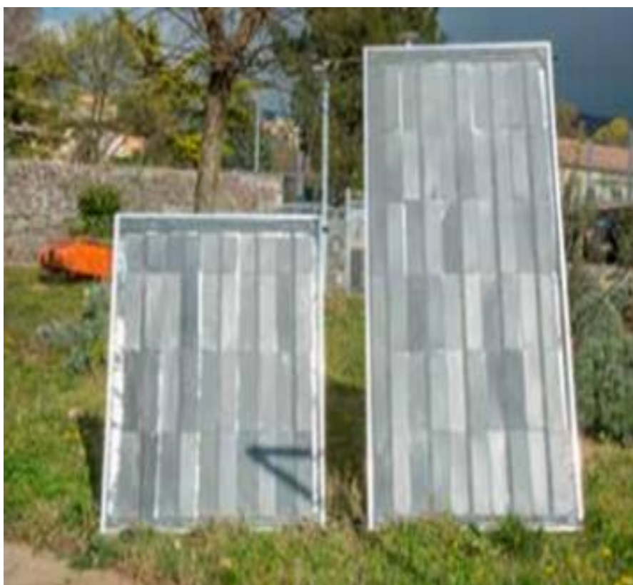
Slika 3.9. Gotovi solarni kolektori
