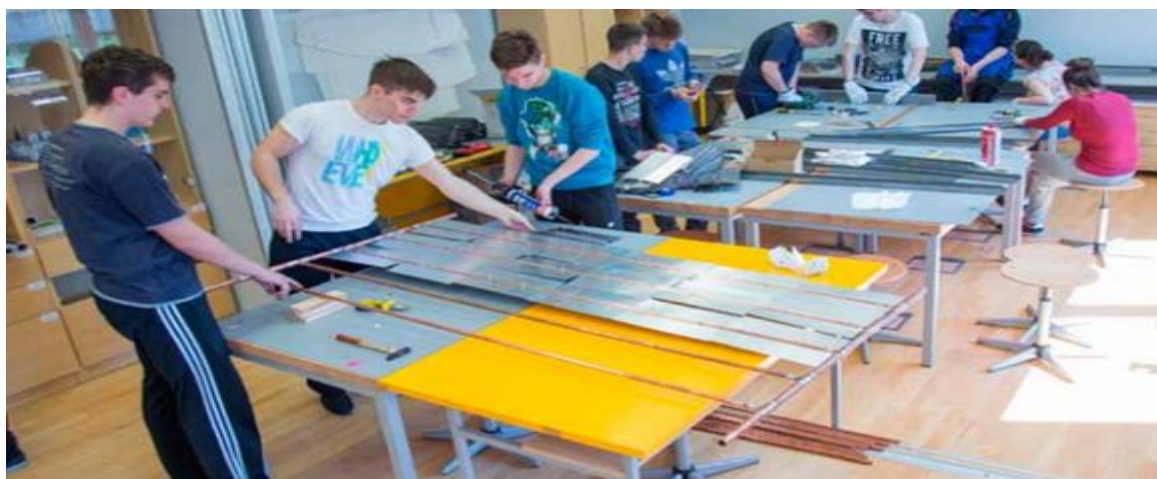
Slika 3.7. Izrada bakrene rešetke i okvira
