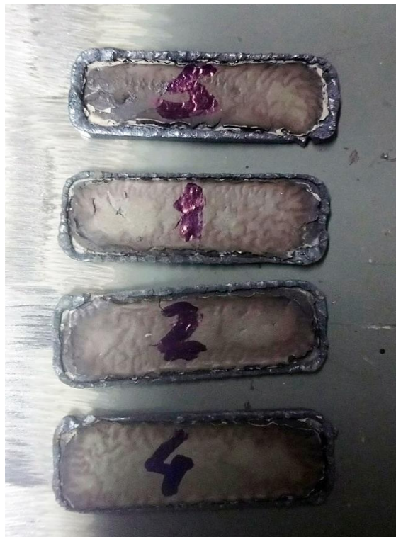
Slika 6.3. Poledina uzoraka odrezanih plazma rezanjem
