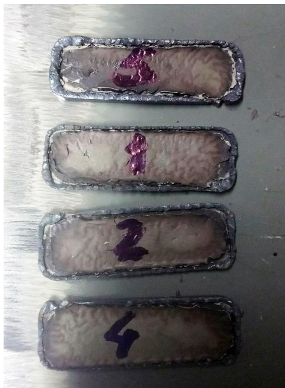
Slika 6.3. Poledina uzoraka odrezanih plazma rezanjem
