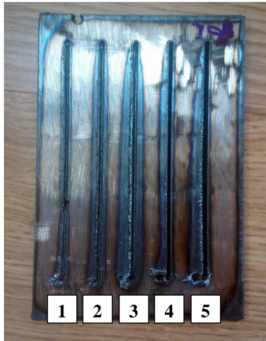
Slika 6.4. Uzorak plazma rezanja uz promjenu struje debljine 3 mm
