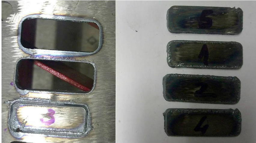
Slika 6.2. Uzorci nakon plazme rezanja
