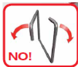
Slika 4.3. b) Uvijanje žice tijekom provlačenja stvara otvorene poluge [12]
