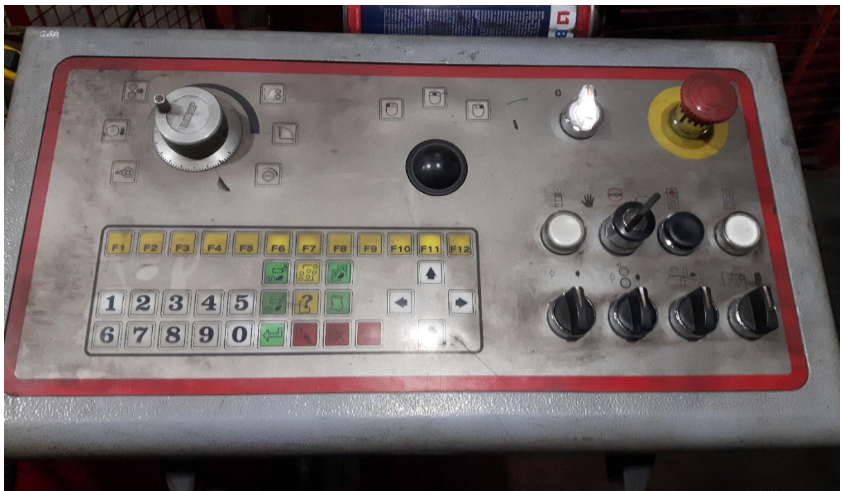
Slika 4.15. Kontrola svih parametara putem potenciometra
