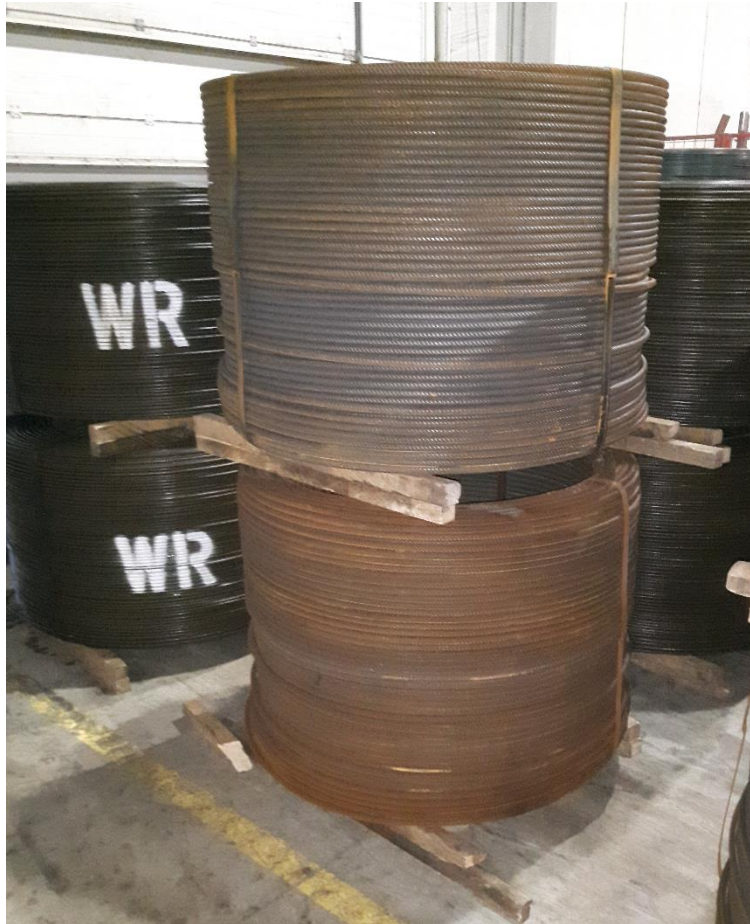
Slika 4.4. Pakiranje betonskog rebrastog željeza
