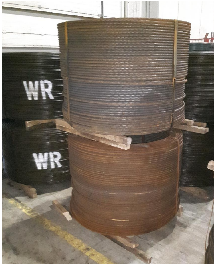
Slika 4.4. Pakiranje betonskog rebrastog željeza
