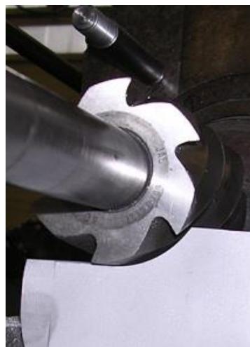
Slika 1.25. Obodno istosmjerno glodanje
