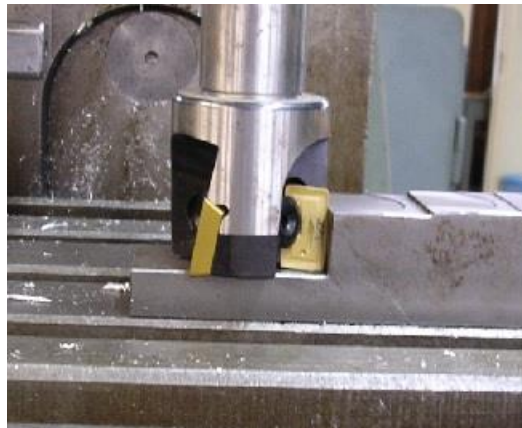
Slika 1.27. Prikaz čeonog glodanja
