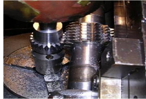
Slika 1.29. Odvalno glodanje zupčanika
